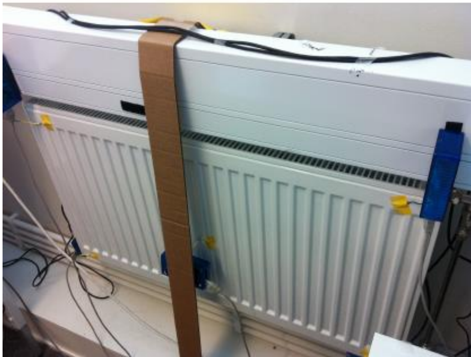
Figura 4.2: Foto e shenjës së bashkangjitur në radiator për të bërë testin për të regjistruar temperaturën mesatare të rrezatimit
