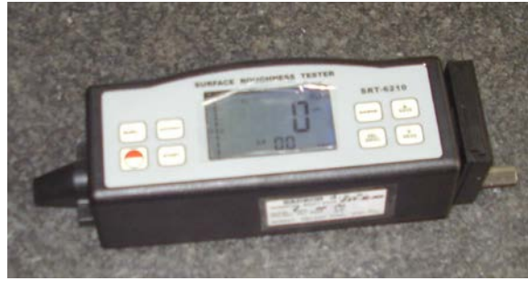
Fig. 5.3.1. Aparati për matjen e ashpërsisë HADRON, SRT-6210
