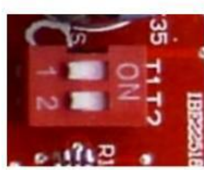
Figura 4.4. T1/T2 dalja e motorëve
