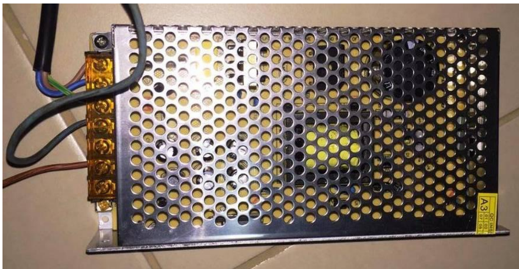
Figura 4.9. Furnizimi me rrymë (Power Supply) 12-24V.
