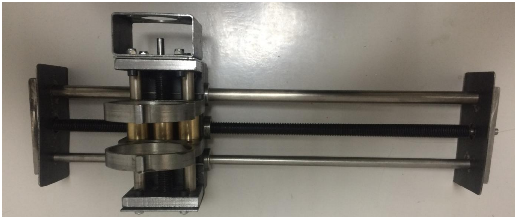
Figura 3.17 Mekanizmi i udhëzuesve lineare për X dhe Z
