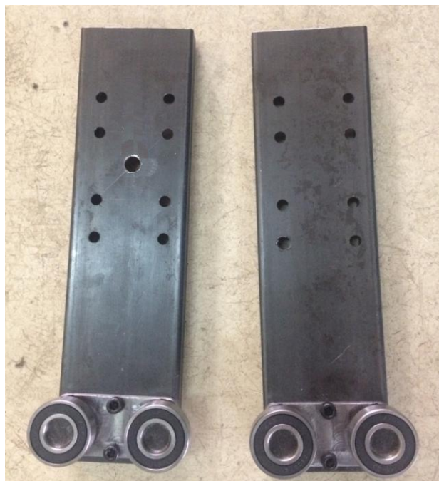
Figura 3.18. Shtyllat vertikale të udhëzuesve lineare për X dhe Z
