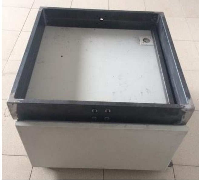
Figura 3.2 Korniza në të cilën do të vendoset pjesa elektronike e makinës
