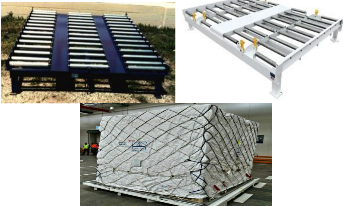
Figura 3.33. Mbajtësit statik të paletave ajrore. [25]
