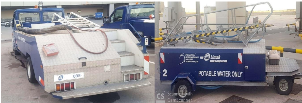
Figura 6.12. Pajisjet për furnizim me ujë të pijshëm dhe pastrim të aeroplanit.
