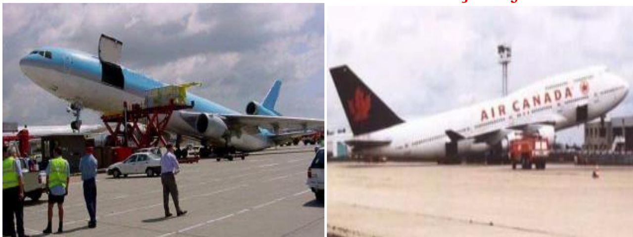
Figura 3.20. Efektet e mos balancimit të aeroplanit gjatë ngarkimit dhe shkarkimit të peshave të aeroplanë. [26]
