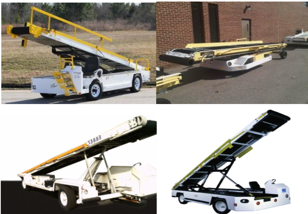
Figura 3.28. Kaishi (traka) për ngarkimin/shkarkimin e mallit/bagazhit nga/në aeroplan. [25]
