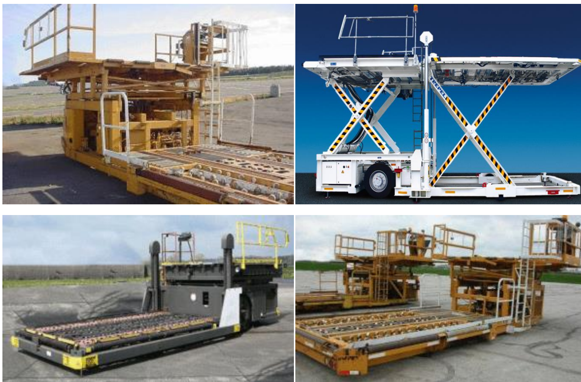
Figura 3.29. Elevatori ose ngritësi i peshave të rënda nga/në aeroplan. [25]
