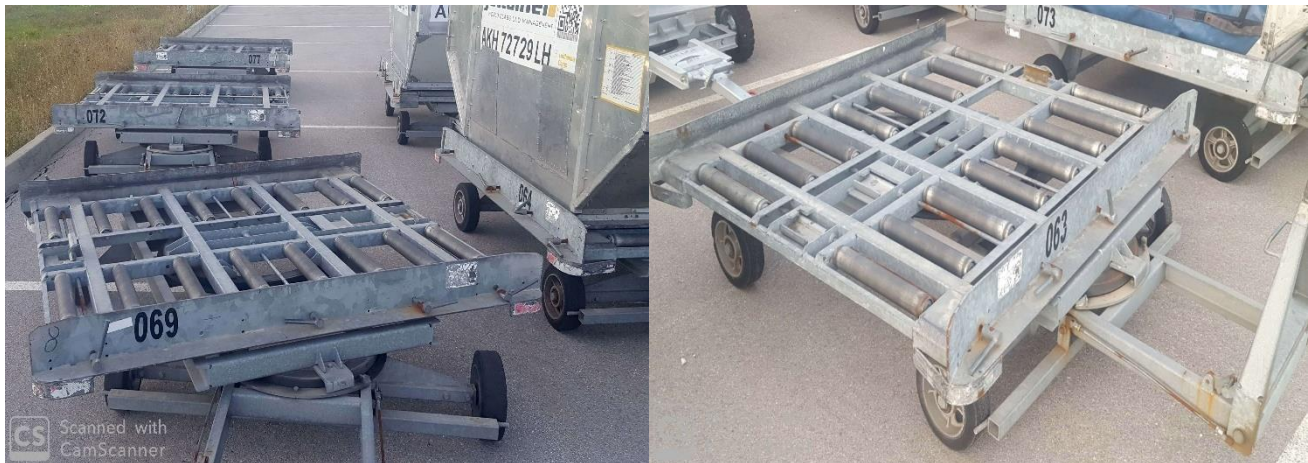
Figura 6.7. Karrocat për bartjen e kontejnerëve.
