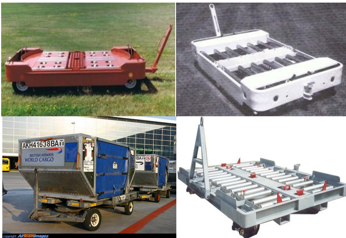
Figura 3.31. Karrocat për bartjen e kontejnerëve ajror. [25]
