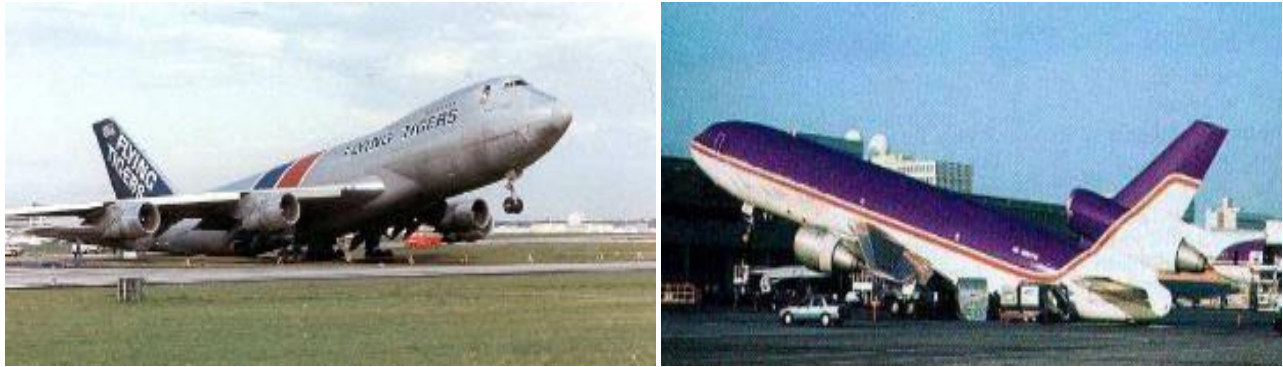
Figura 3.21. Efektet e mos balancimit të aeroplanit gjatë ngarkimit dhe shkarkimit të peshave të aeroplanë. [26]
