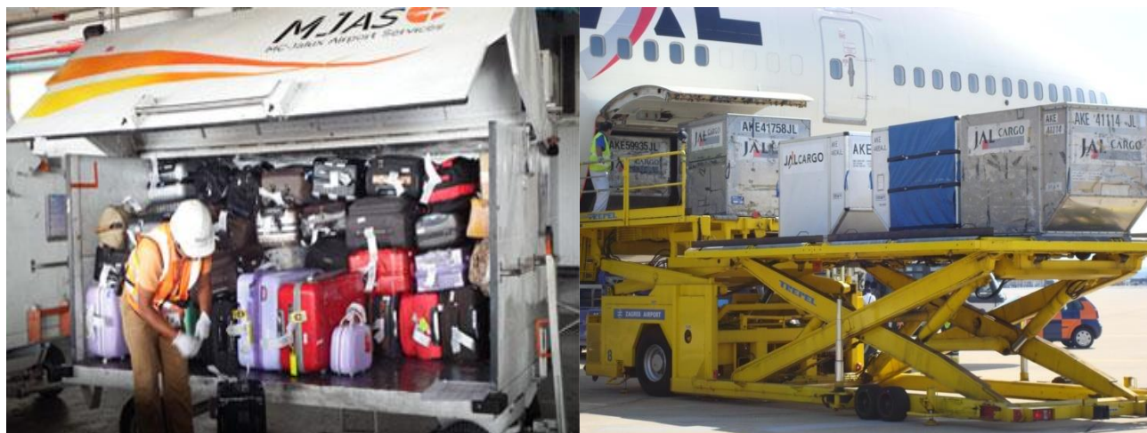
Figura 3.17. Teknikat e ngarkimit/shkarkimit të bagazhit dhe mallrave nga/në aeroplanin. [16]
