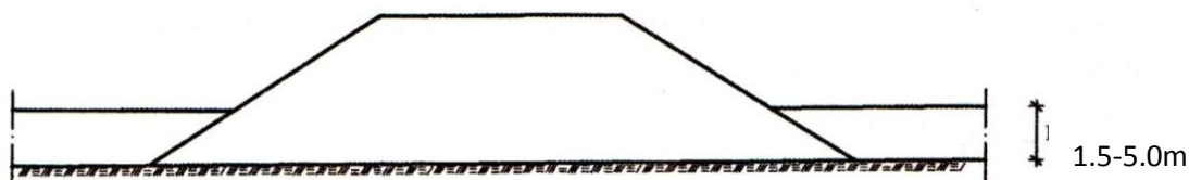
Fig.5.18.Mbushjet në terrenin me bartje të dobët në mes 1.5 m deri 5.0 m.
