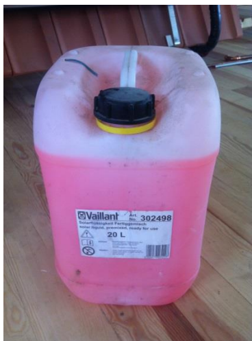
Fig. 3.11. Fluid punues nga Vaillant i lëngshëm: Propilen glykol 42% dhe 58% ujë.
