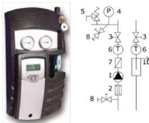
Fig. 3.6. Pompa dhe elementet tjera të nevojshme: 1. Pompa, 2. Matësi i qarkullimit, 3. Valvula sferike me holander, 4. Manometri, 5. Valvula e sigurisë, 6. Termometri, 7. Valvula jokthyesë, 8. Valvula për mbushje dhe zbrazje, 9. Filtri i papastërtive, 10. Valvula për ç'ajrosje.
