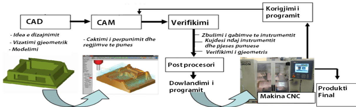
Fig. 2.2. Sistemi i funksionimit të makinave CNC
