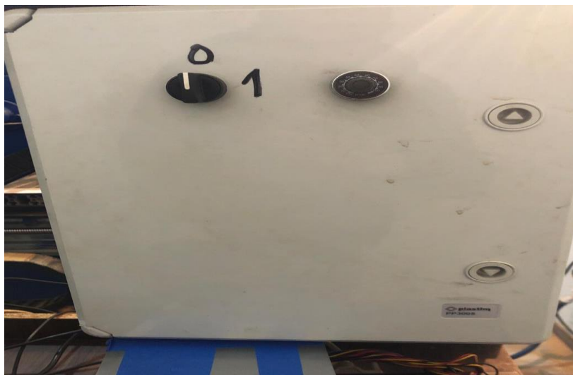
Figura 5.20. Ndërprërsi i spindelit dhe rregullatori i shpejtësisë.
