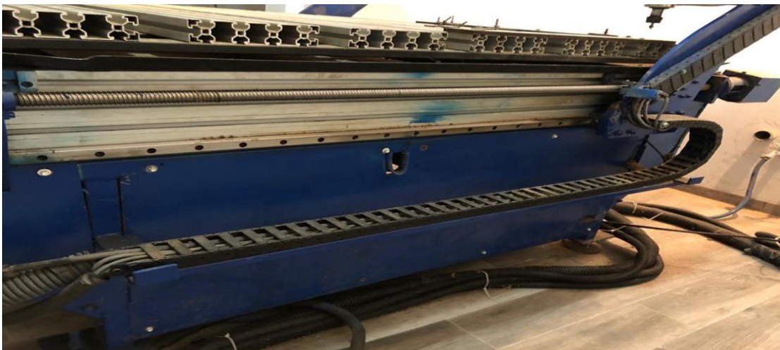
Foto 3. Shiritat e kabllorë së stepper motorave dhe gypit të ujit lëvizëse aksi Y
