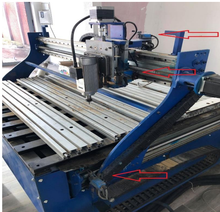
Figura 3.44. Kufizuesit mekanik (Limit swich) dhe montimi i tyre
