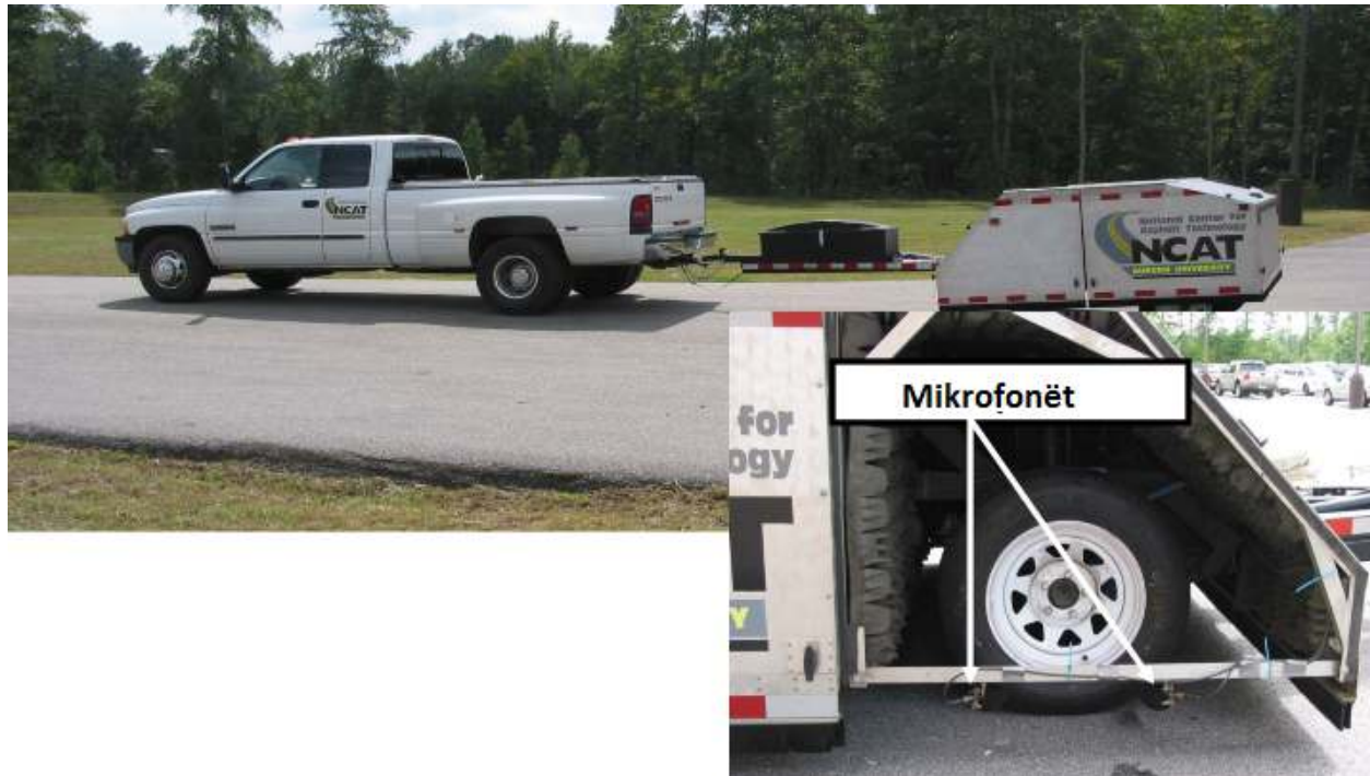
Fig 4.5 Metoda për matjen e zhurmës së gomave SIO 11919-2 [16]
