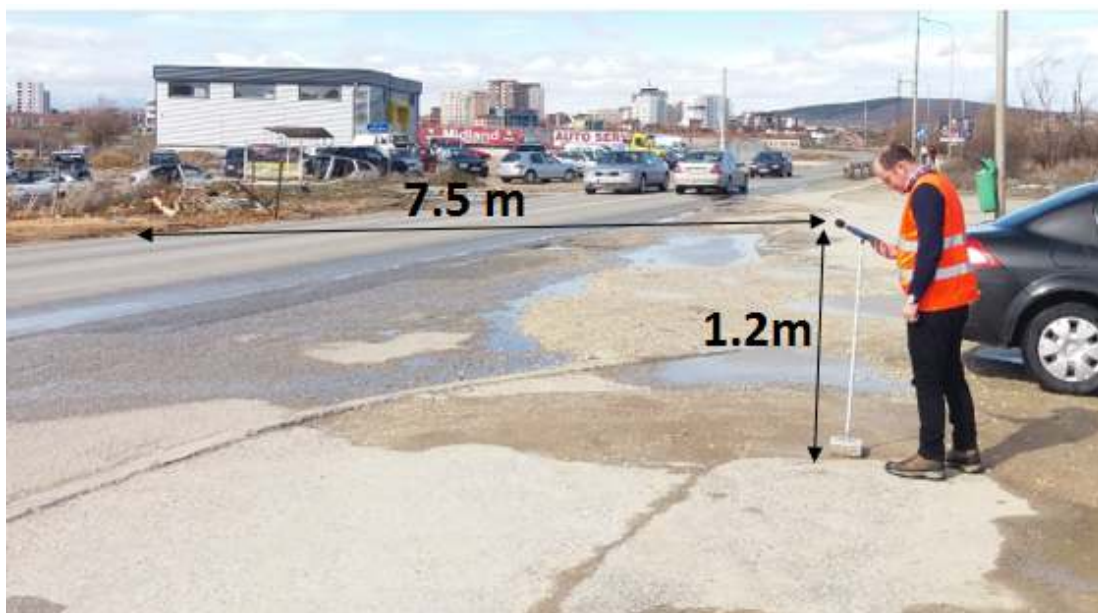
Fig 3.13 Pozicionimi i aparatit për matjen e zhurmës në teren
