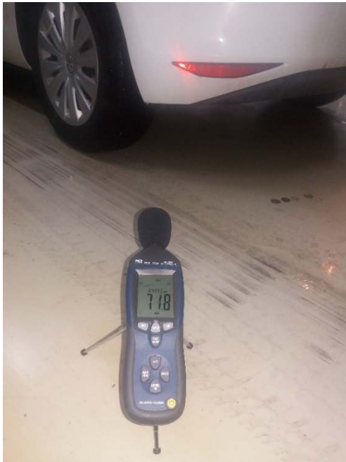
Fig 3.5 Matja zhurmës të automjetit dizel
