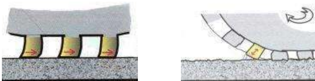
Fig. 4.7, (a) Stick-slip (veprime tangenziale) (b) Stick-snap (veprime radiale) [11]
