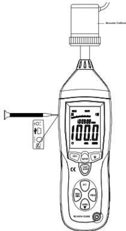
Fig 3.2 Kalibrimi i fonometri PCE 322A [22]
