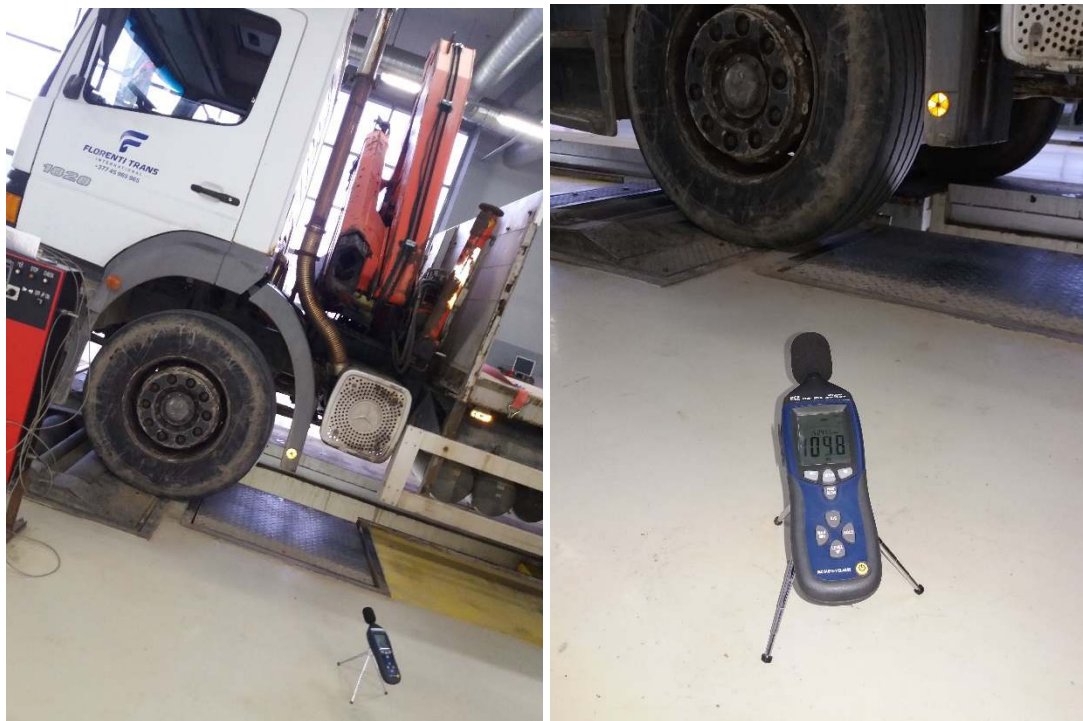
Fig 3.9 Pozicionimi i aparatit për matjen e zhurmës që krijohet nga kamionët sipas ECE direktivës
