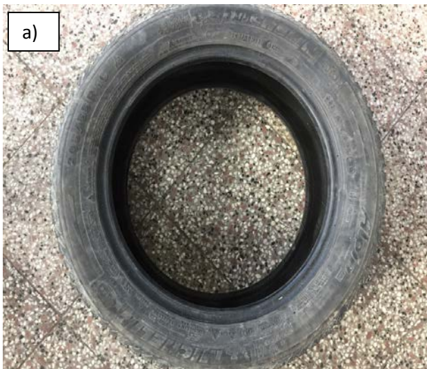
Figura 6.27. Pneumatiku i prodhuesit "Sava" i prodhuar me 33/11, me shenja identifikuese: 205/55 R16
