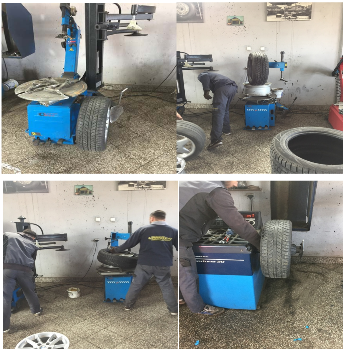
Figura 6.29. Procesi i ndërrimit të pneumatikëve dhe balancimi i tyre
