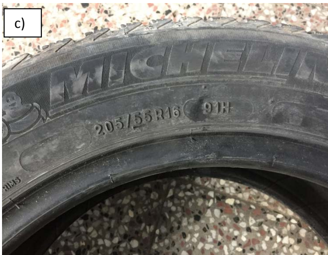
Figura 6.28. Pneumatiku i prodhuesit “Michelini” i prodhuar me 11/13, me shenja identifikuese: 205/55 R16
