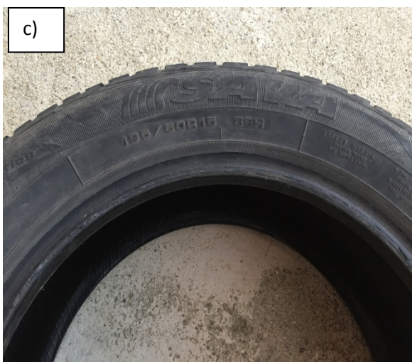
Figura 6.24. Pneumatiku i prodhuesit “Sava” i prodhuar me 06/13, me shenja identifikuese: 195/60 R15
