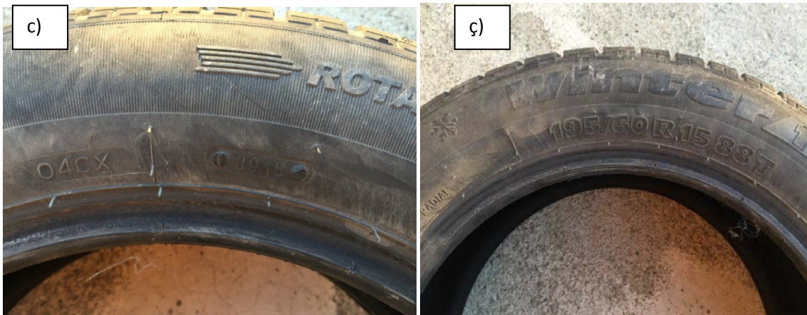
Figura 6.23. Pneumatiku i prodhuesit “Tigar” i prodhuar me 39/16, me shenja identifikuese: 195/60 R15
