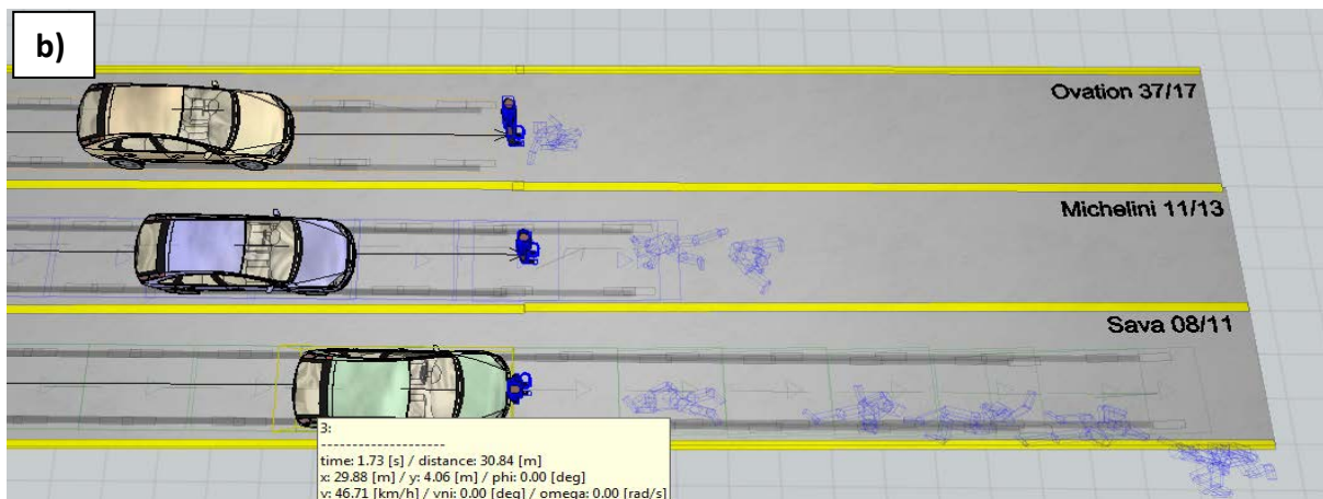
Figura 8.6. Rasti 2: Shpejtësitë e përplasjes së automjetit më këmbësorin; a) shpejtësia e automjetit me pneumatik Michelin, b) Shpejtësia e automjetit me pneumatik Sava 33/11
