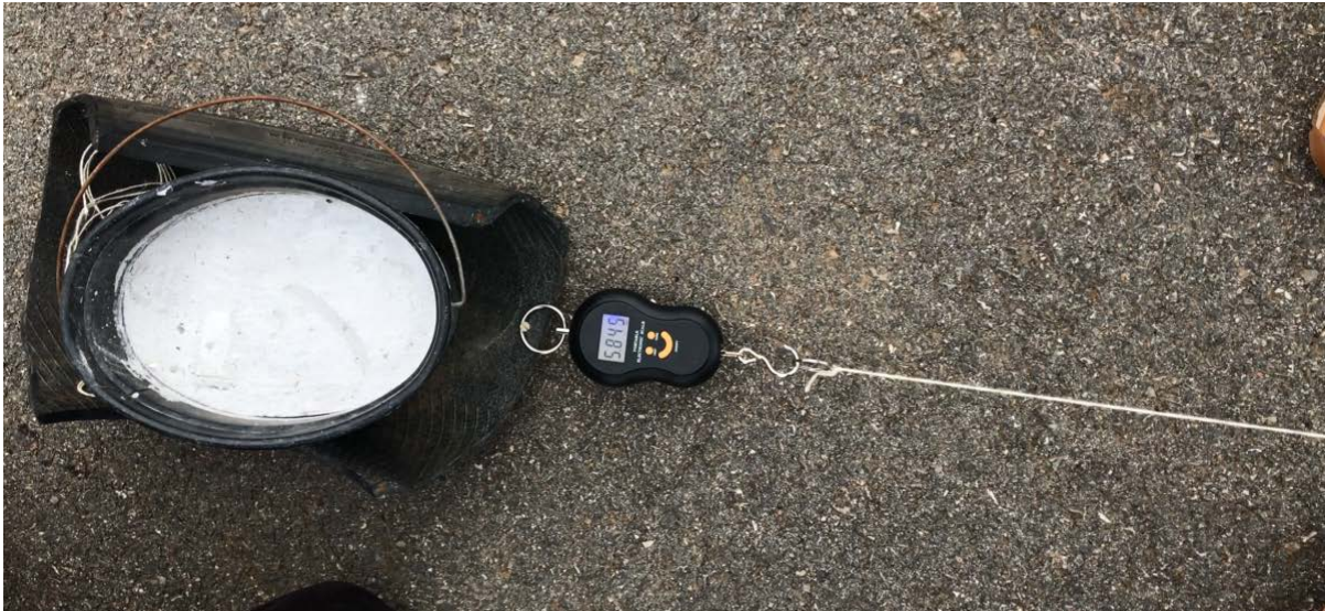
Figura 6.31. Procesi i matjes të matjes së koeficientit dinamik të fërkimit.
