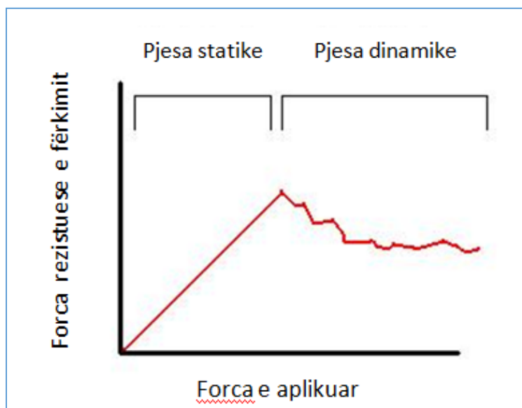
Figura 4.6. Diagrami i koeficientit të fërkimit statik dhe dinamik [17]
