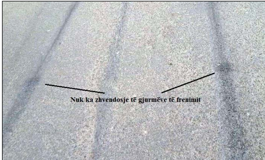
Figura 6.128. Gjurmët e frenimit pas ndërrimit të amortizatorëve
