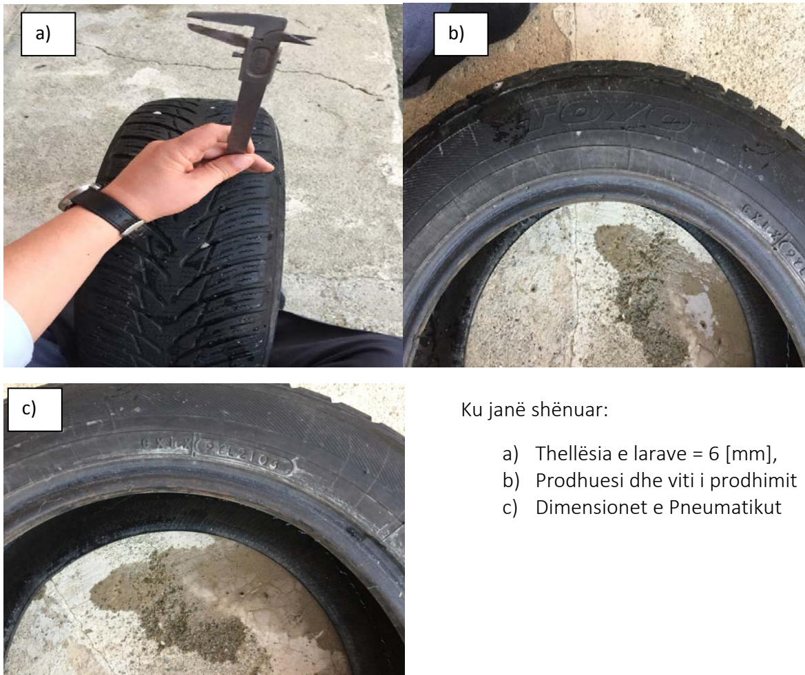
Figura 6.25. Pneumatiku i prodhuesit "Toyo" i prodhuar me 21/03, me shenja identifikuese: 195/60 R15 Pneumatiku Toyo 21/03, dhe karakteristikat e tij
