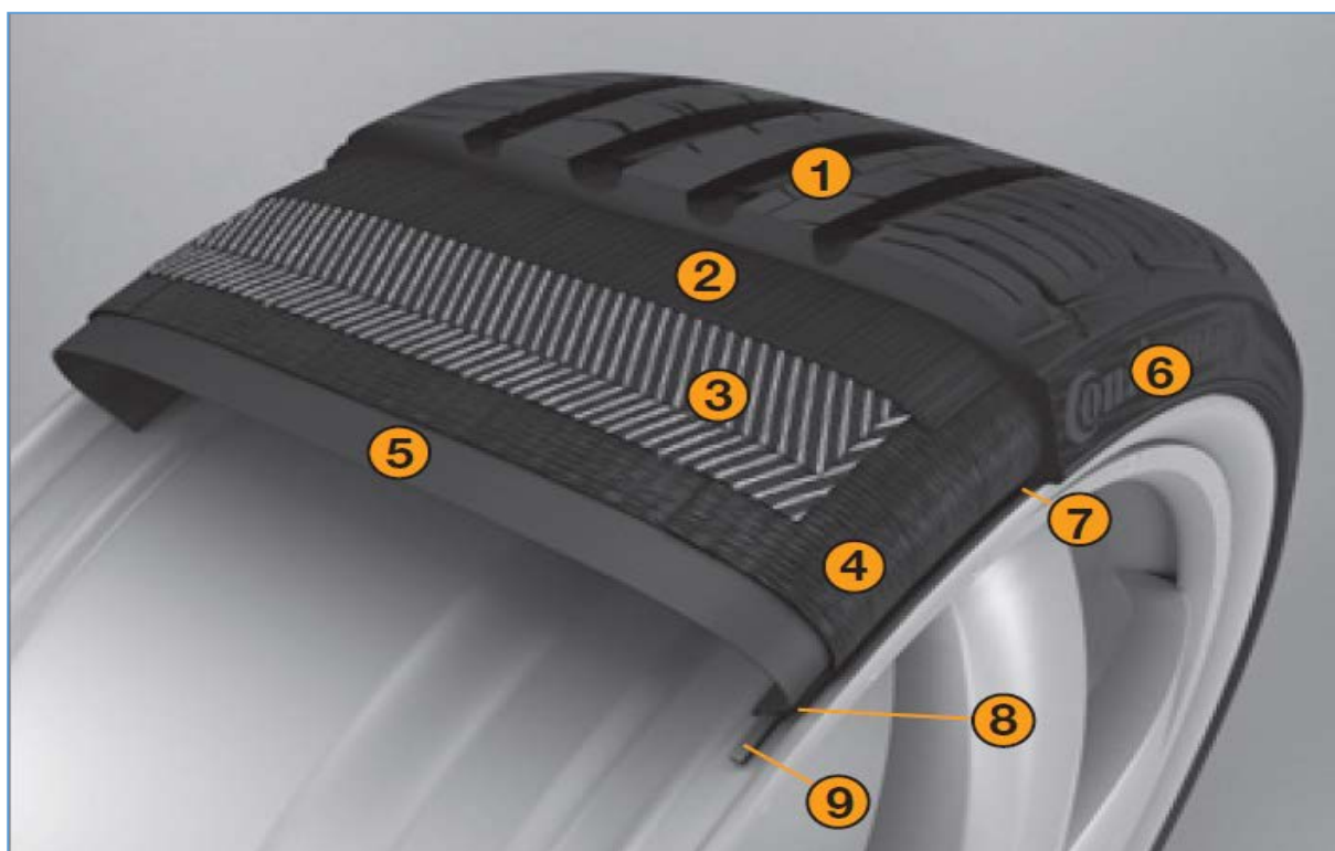
Figura 5.7. Pneumatiku i automjetit të udhëtarëve dhe pjesët përbërëse të tij [18]
