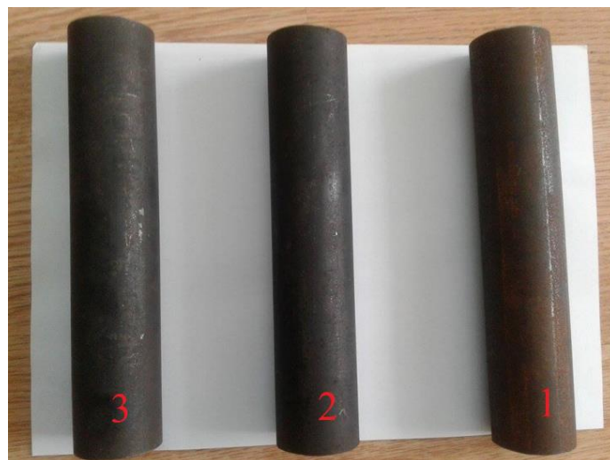
Figura 6.1: Materiali i ekzaminuar ( çeliku në tri nivele të fortësisë)
