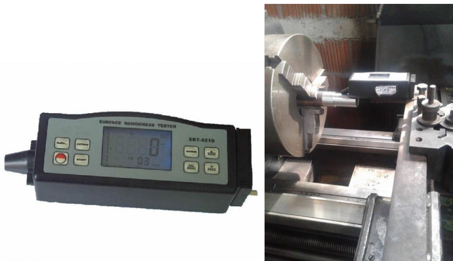
Figura 6.4: Aparati për matjen e ashpërsisë HADRON, SRT-6210
