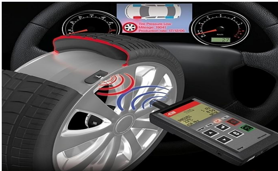
Fig.22 Paraqitja e vendosjës së sensorit për matjen e presionit.
