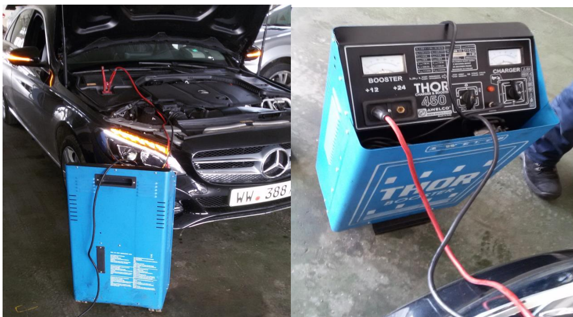
Fig. sh. 10 Vendosja e kablllove në bateri nga pajisja për furnizim me energji elektrike (starteri).
