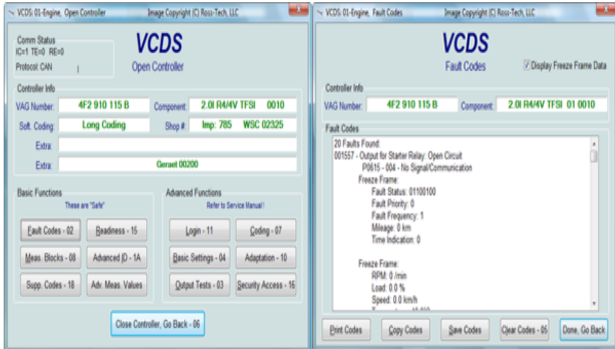
Fig. 55 Paraqitja e opsioneve për skanim në ekranin e kompjuterit nga pajisja VAG-COM.
