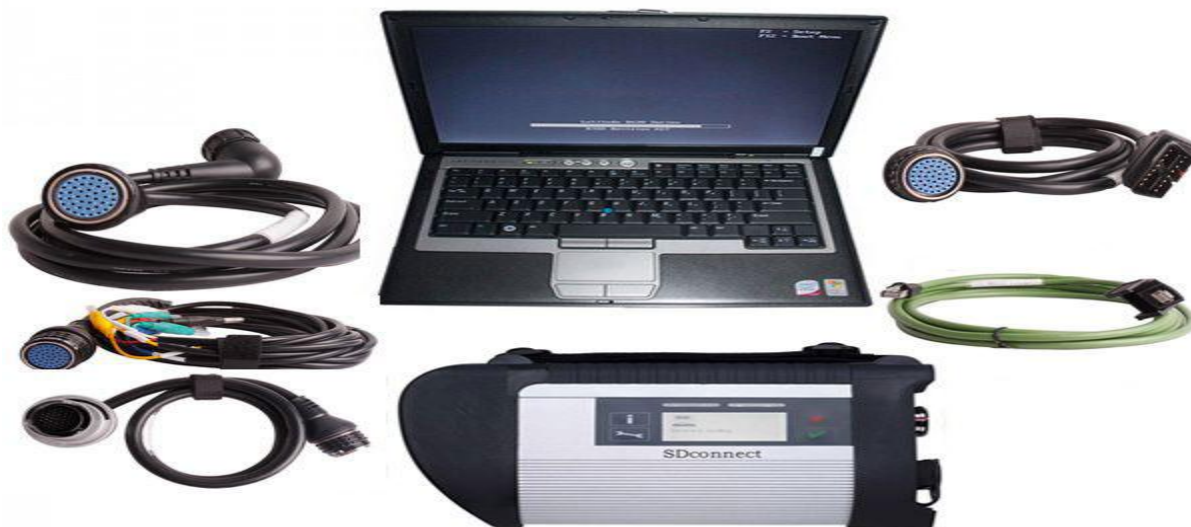
Fig. sh. 8 Komponentet për diagnostifikim si: laptopi, pajisja diagnostike XENTRY, Kabllot për kumunikim.
