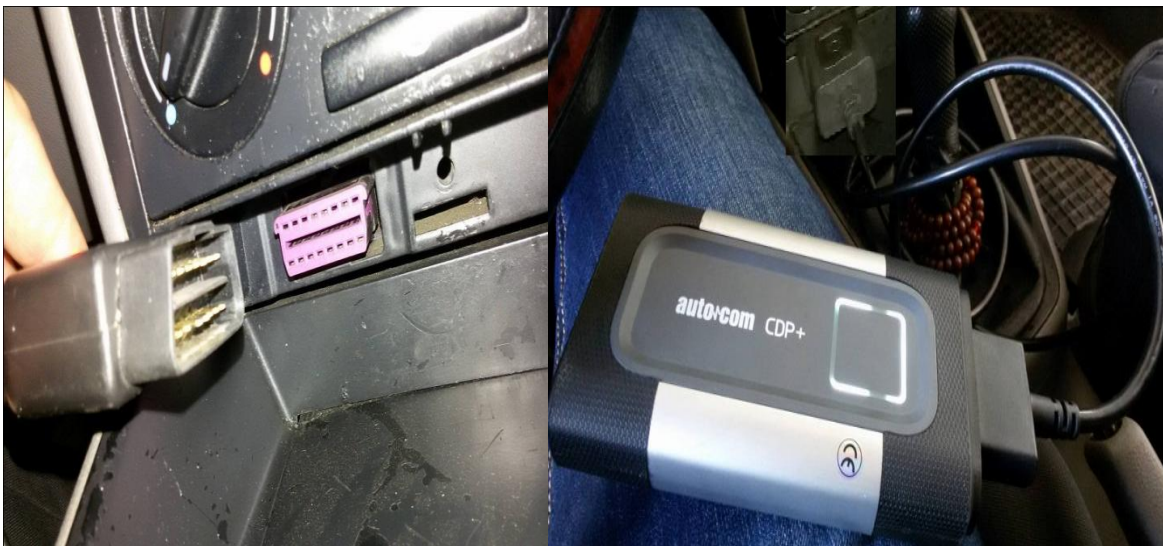
Fig.62 Konektimi i pajisjes diagnostike CDP + me kompjuterin e automjetit(On bord diagnostic) që tregon me ndezjen e dritës LED me ngjyrë të kaltër.
