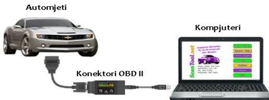
Fig.39 Lidhja përmes konektorit OBD II diagnostifikus.
