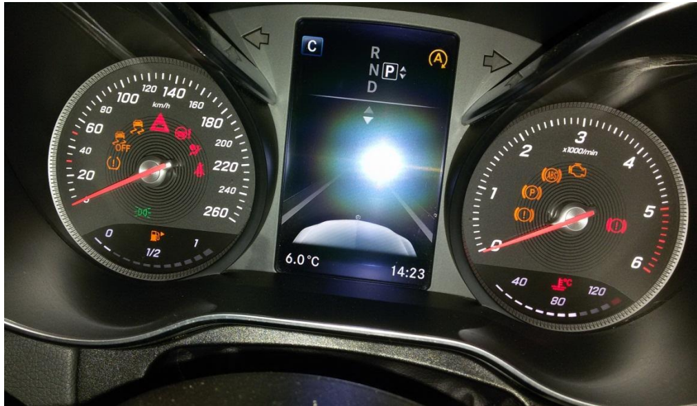
Fig. sh.9 Paraqitja e instrument tabelës me llamba të ndezura gjatë diagnostifikimit të Mercedes Benz C 220 me vit të prodhimit 2015.
