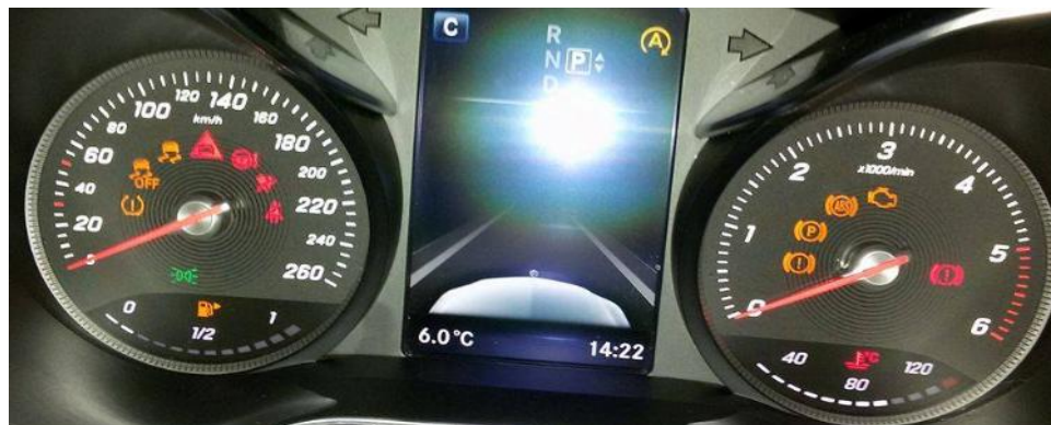
Fig.31 Drita që mund të ndizen në tabelën e instrumenteve për ndonjë prishje te automjetet moderne.
