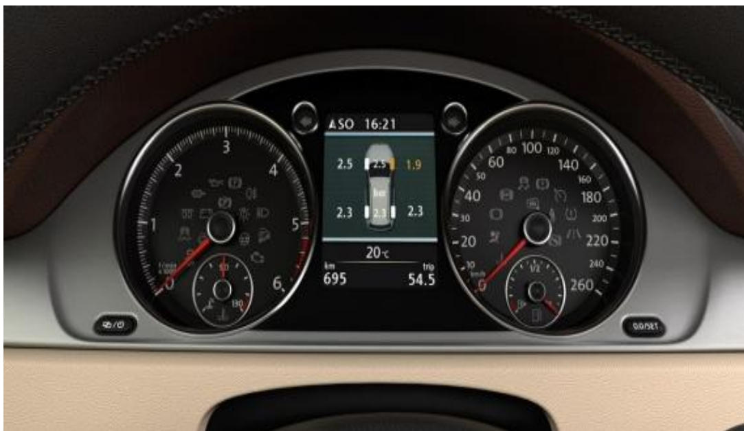
Fig.21 Në tabelën e instrumenteve tregohet se një gomë nuk është në presionin e duhur.
