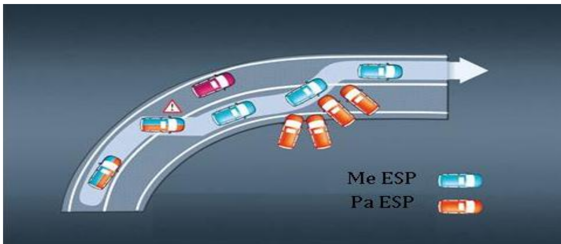
Fig. 9 Automjeti me sistemin ESP dhe pa ESP duke lëvizur në një kthes.
