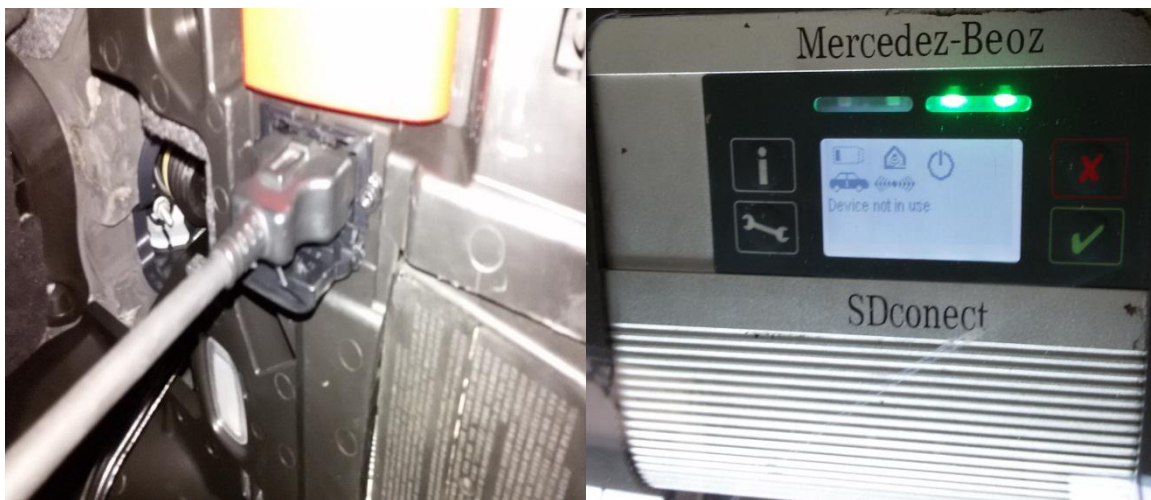
Fig. sh. 12 Konektimi në mes pajisjes diagnostike dhe automjetit.
