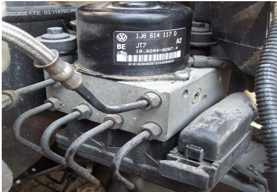
Fig.sh.6 Me konstatimin me defekt të pompës hidraulike të ABS-it u bë ndërrimi me një pompë hidraulike të ABS-it tjetër në gjendje të rregullt.
