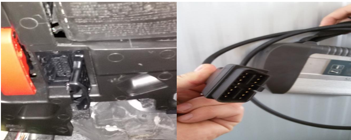
Fig. sh. 12 Priza që lidhet me sistemin elektronik të automjetit dhe kyçësi me pajisjen diagnostike XENTRY.
