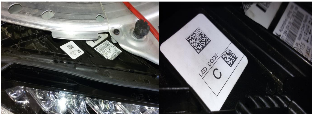
Fig. sh. 14 Leximi i kodeve në farin e automjetit që janë të vendosura në tiket.
