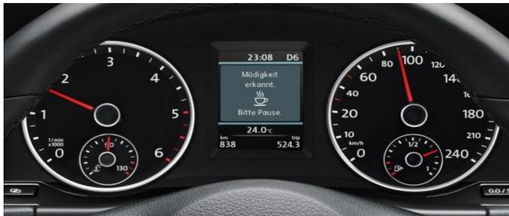
Fig.23 Tabela e instrumenteve (paneli i instrumenteve) paraqitet shenja e kafes, që paralajmëron ngasesin se është i përgjumur dhe i duhet pushim.
