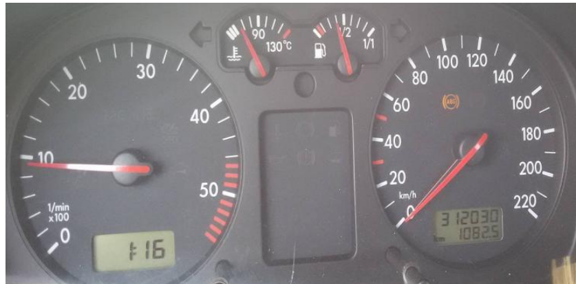
Fig.sh.1 Ndezja e llambës së ABS në tabelën e instrumenteve.
