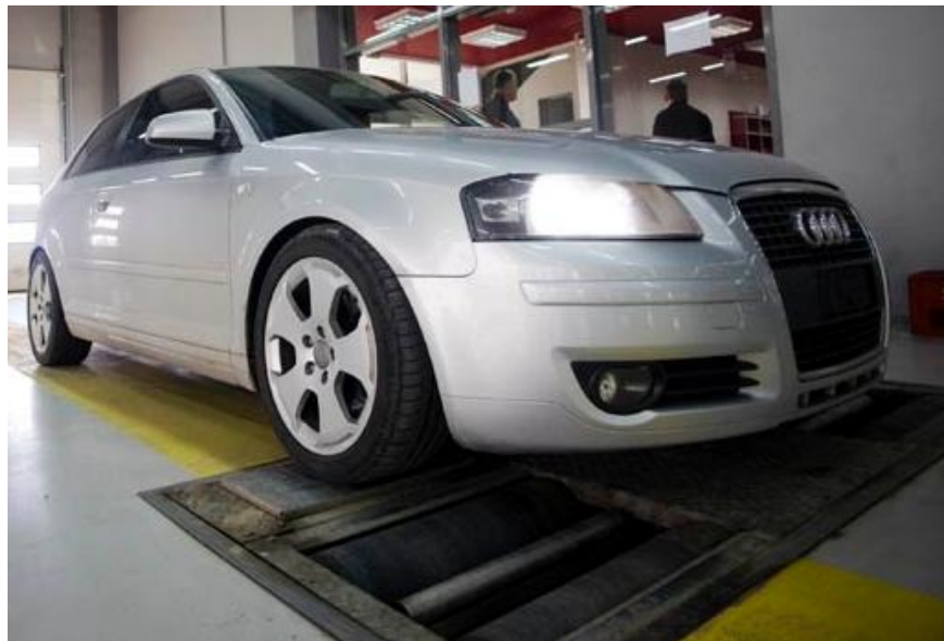
Fig.43 Pamja e një automjeti duke u testuar mbi pllakat shkelëse [18].
