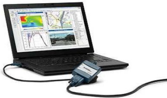
Fig. 59 Foto tregon pajisjen 8473s NI USB e lidhur në kompjuter dhe bën analizua e të dhënave të mbledhura nga busi CAN [13].
