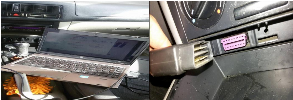
Fig.sh.2. Pajisja diagnostike VAG, laptopi, kyçësi dhe priza që është e lidhur me sistemin elektronik në automjet.
