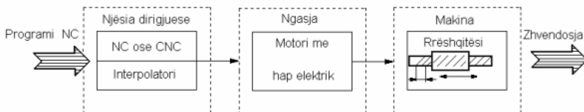
Fig. 2.4. Principi i dirigimit me lëvizjen ndihmëse me hap elektrik. [1]
