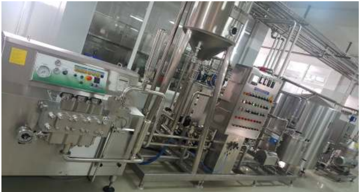
Fig. 1.2. Linja e prodhimit në industrinë e qumështit e programuar me Simatic S7.
