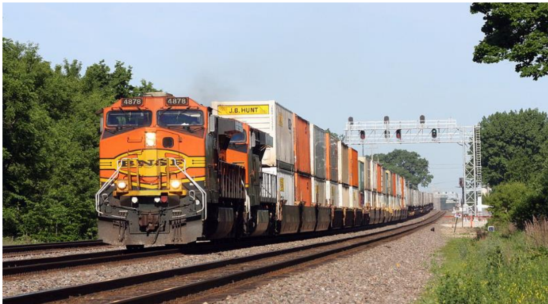
Figura .3.17. Transporti i kontejnerëve në dy radhë të sistemi Pigy back.
