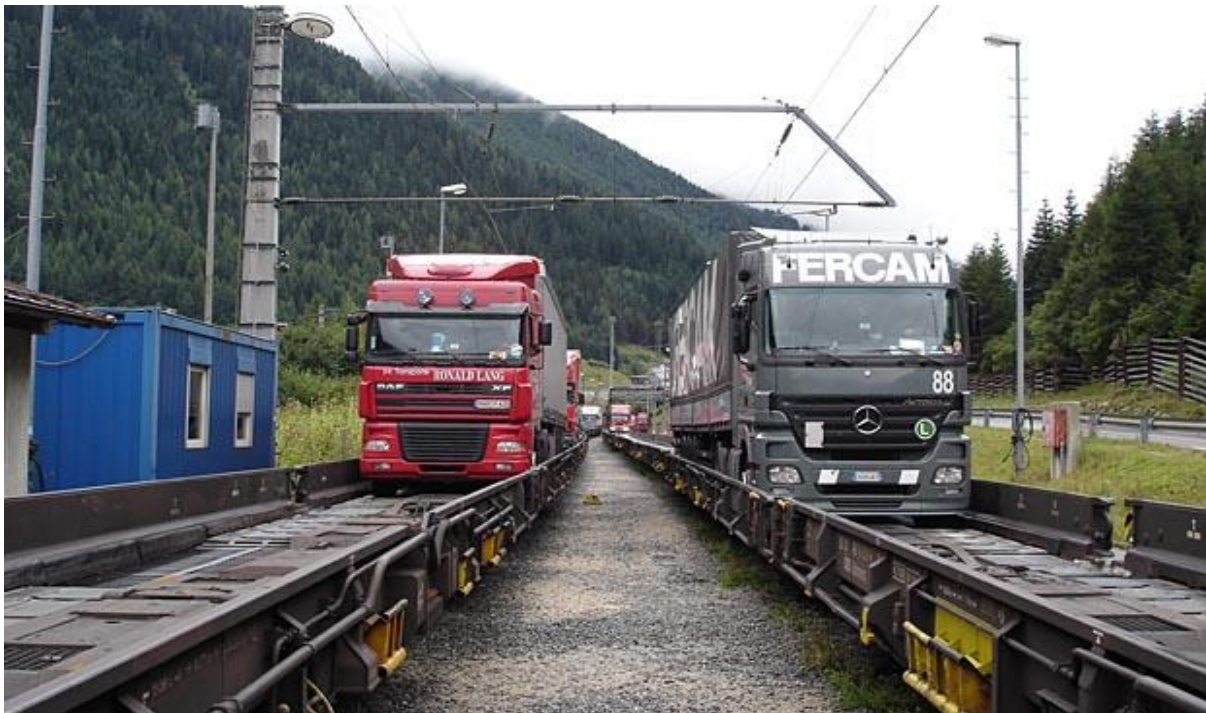
Figura.3.6.Pamja e lidhjes së vagonëve më dyshe të ulët (pista për lëvizje të mjeteve rrugore).
