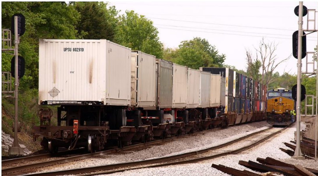
Figura .3.16. Transporti i kombinuar te sistemi Pigy Back (kontejner- gjysmë rimorkio).
