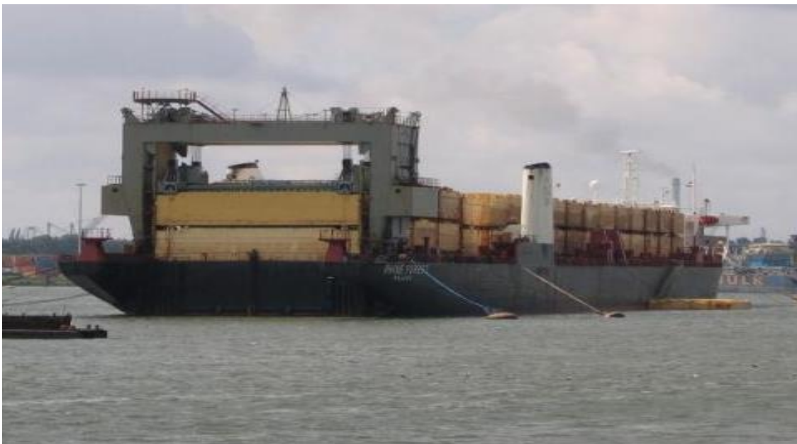
Figura.7.3. Anija FËRER LASH për tubimin e barzhave-maonave.
