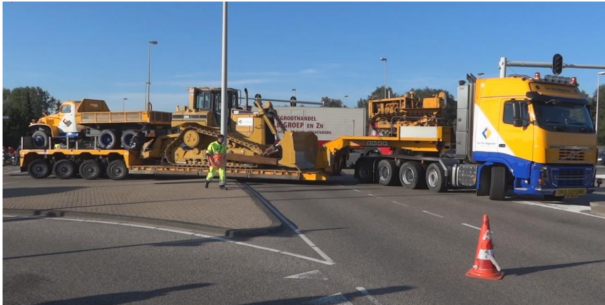
Figura.2.2. Transporti i mjeteve tjera rrugore më kamion më rimorkio speciale.
