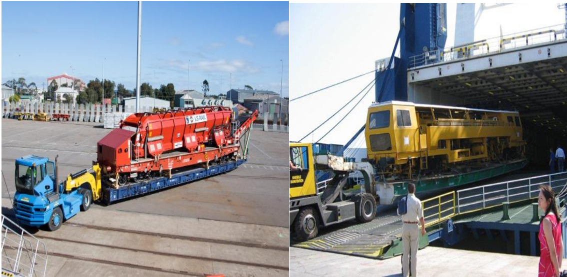
Figura.6.7. Bartja e mjetit hekurudhor nga terminali deri në anije dhe ngarkimi horizontal përmes rampës ngarkuese.
