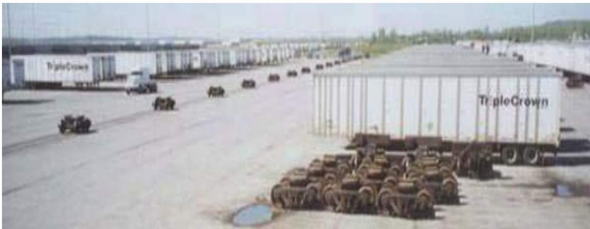
Figura.3.24. Terminali i sistemit te transportit bimodal.
