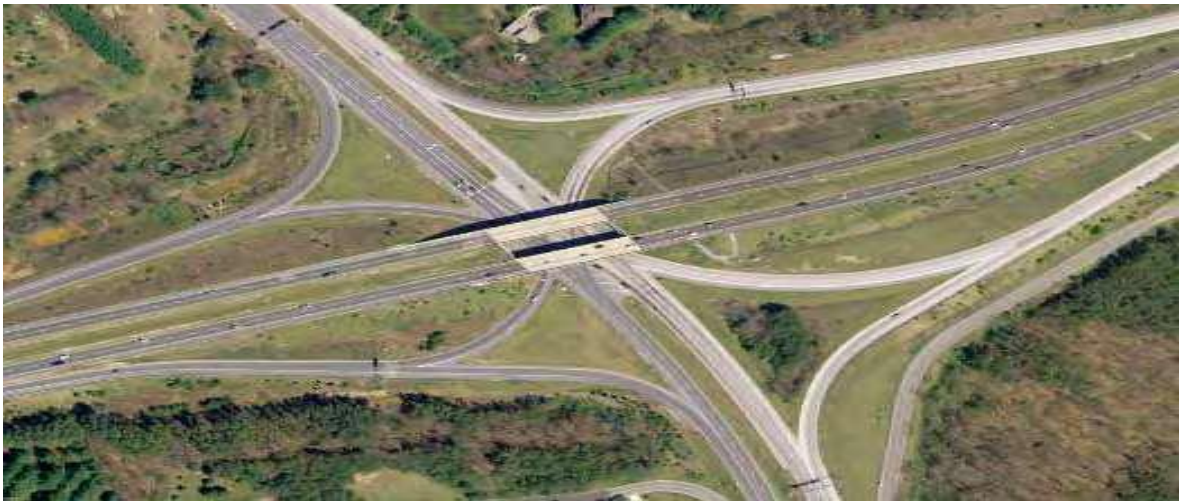
Fig. 2.6.4.2 paraqet udhëkryqit në disnivel diamant me një pikë me rrugë kryesore e cila rasti par paraqet ku rruga kryesore është mbi kalim.
