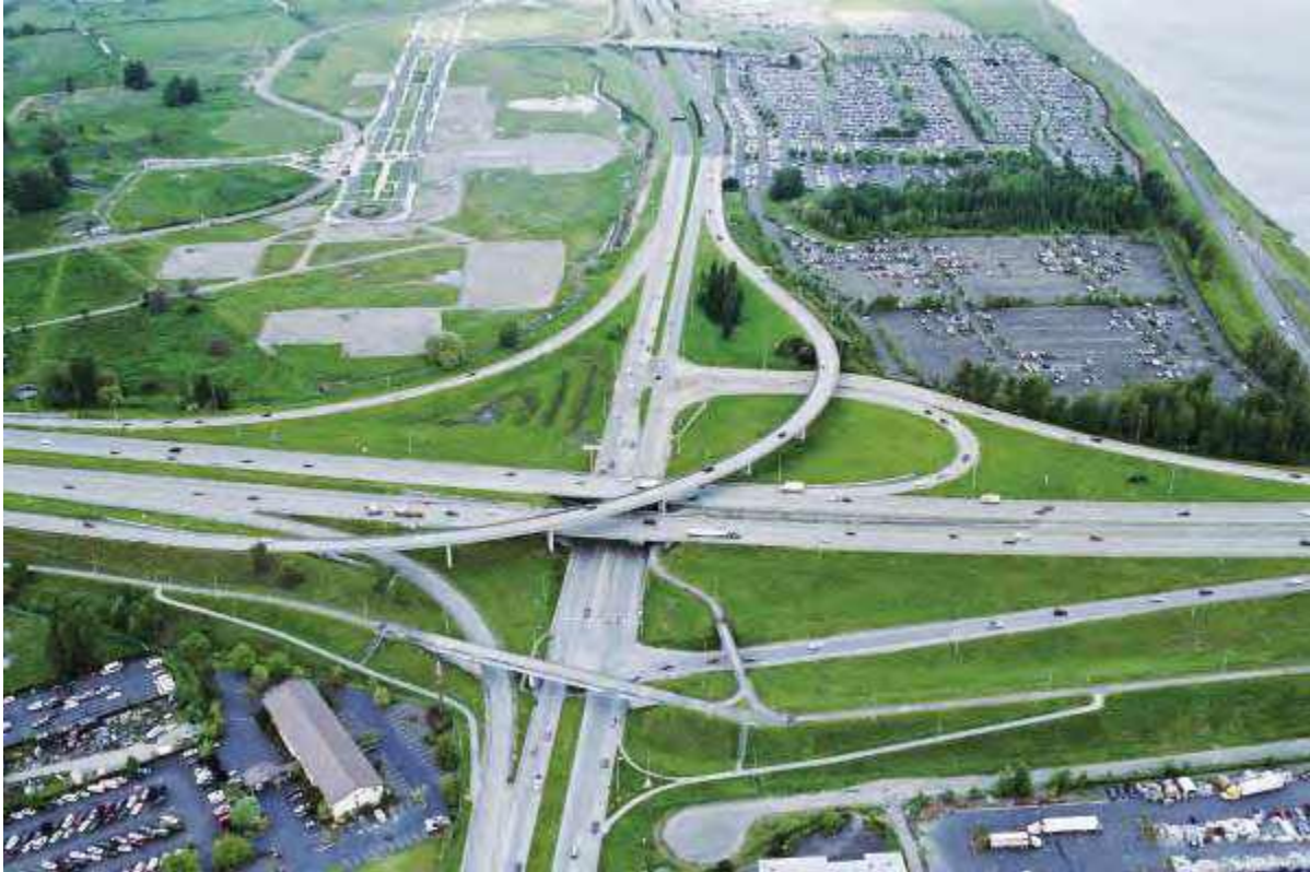
Fig 2.7.2.1 Udhëkryqi në disnivel ekzistues (në shtetin e Oregonit USA), me katër krahë i llojit diamant me lidhjen e rampave direktet dhe me një rampë të harkuar për auto-rrugën me katër shirita, pra për (DK-Drejtimin kryesor.)
