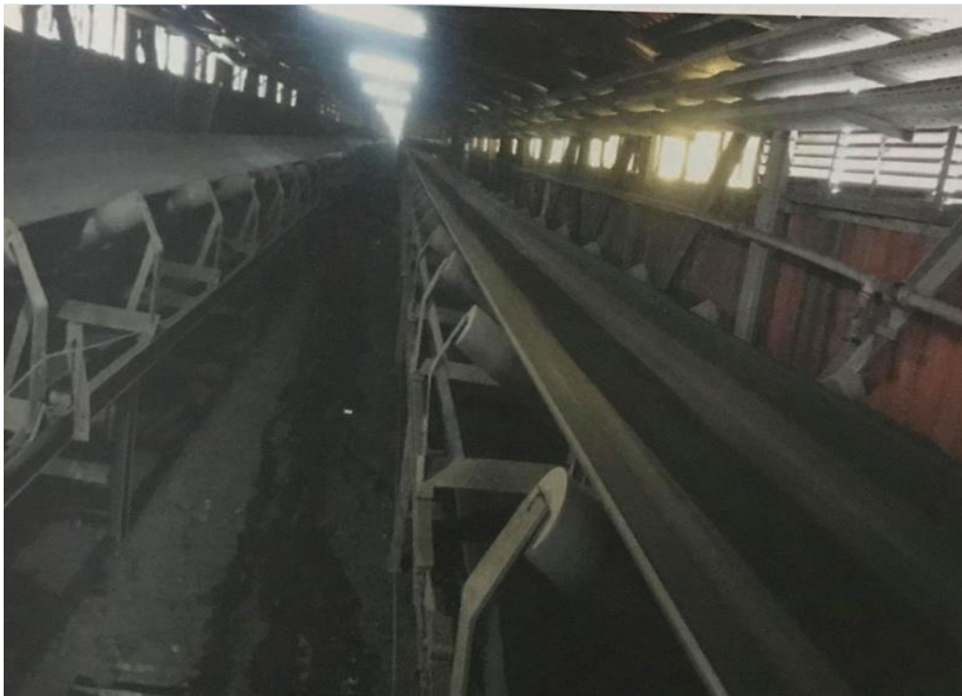
Figura 7. 3 Shiritat transportues OPB02 dhe OPB03 për transportimin e qymyrit deri në kuotën 62 m.
