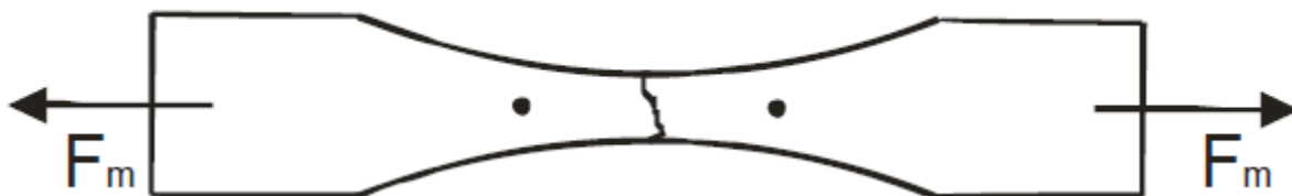
Figura 6. 1 Kampioni standard për testimin e shiritave me shtresë tekstili [13]
