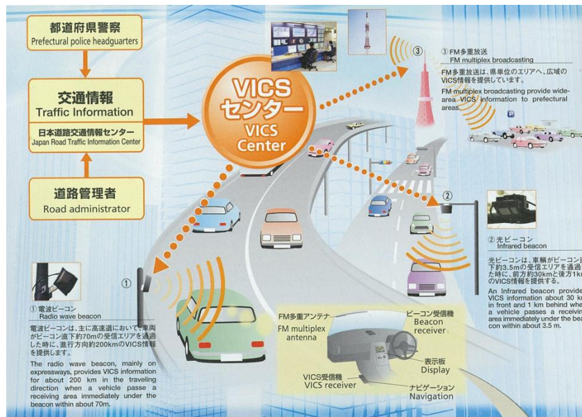
Fig. 3. 2 Sistemi i informimit dhe komunikimit të automjeteve VICS Japoni 23
