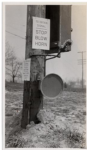
Fig.2. 2 Sensorë i parë me zë i shpikur nga Charles Adler Jr. në vitin 1928 [ https://spectrum.ieee.org/tech-history/dawn-of-electronics/the-man-who-invented-intelligent-traffic-control-a-century-too-early ]
