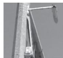
Senzori shumë shiritor ITMS-100 i furnizuar me energji solare, ofron numërimin e automjeteve, matjen e shpejtësisë dhe klasifikimin në bazë të shiritave. Po ashtu edhe bënë detektimin e temperaturës së sipërfaqes së rrugës për të përcaktuar kushtet e borës dhe akullit
