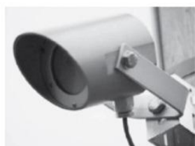
Senzori shumë zonësh ASIM IR 254/5 bënë numërimin e automjeteve, matjen e shpejtësisë, klasifikimin e automjeteve në bazë të gjatësisë dhe bënë detektimin e prezencës së
