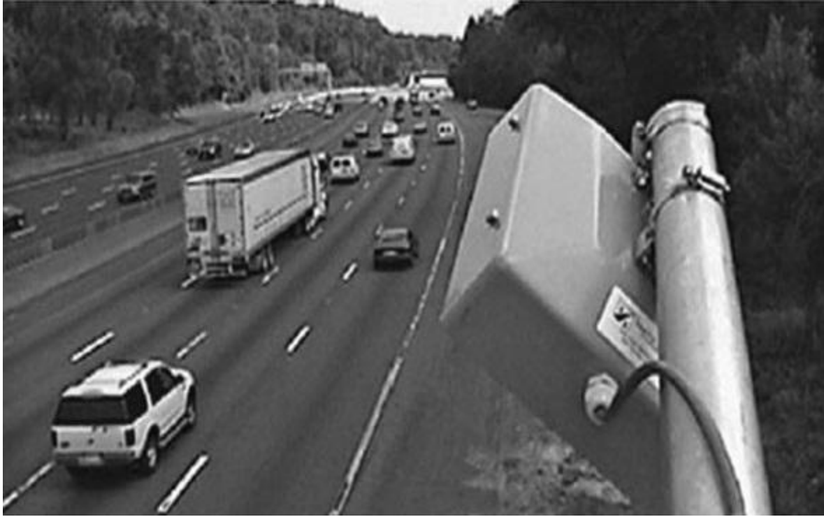
Fig. 5. 16 Detektori pasiv akustik SAS-I 10
