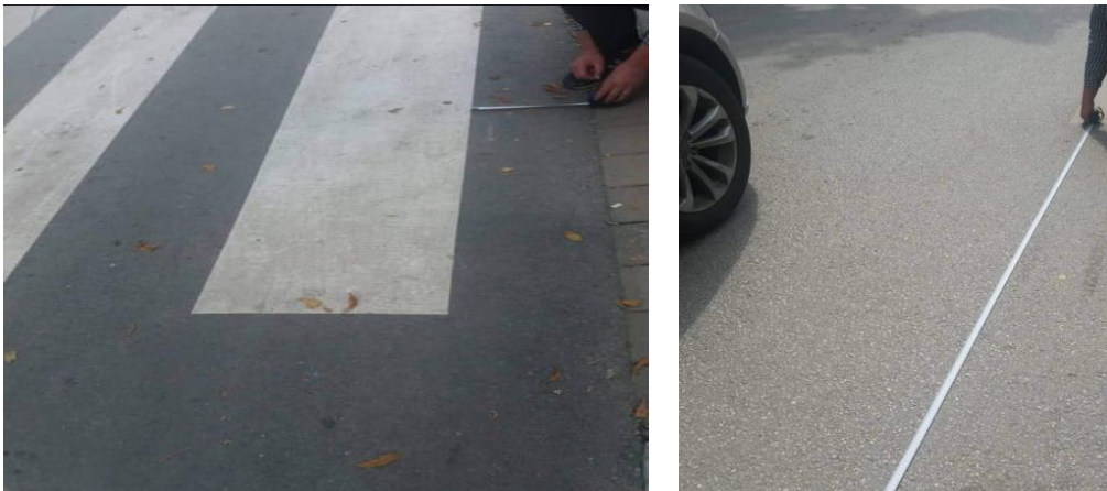
Figura 4.19: Matja manuale e dimensioneve të vendkalimit të këmbësoreve dhe vijave gjatësore
