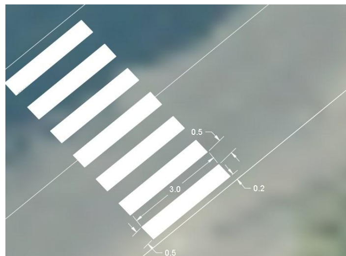
Figura 2.16: Dimensionet e vendkalimit të këmbësorëve
