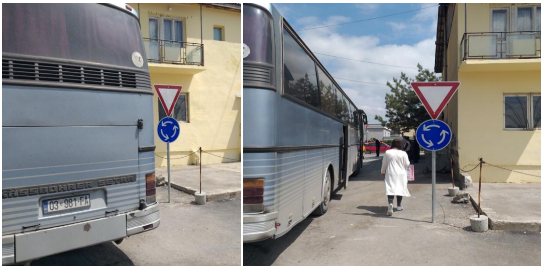
Figura 4.7: Dukshmëria e rrezikuar e shenjës e cila paralejmron udhëkryqin e formës rrethore dhe kryqëzimin me rrugë me përparësi kalimi.
