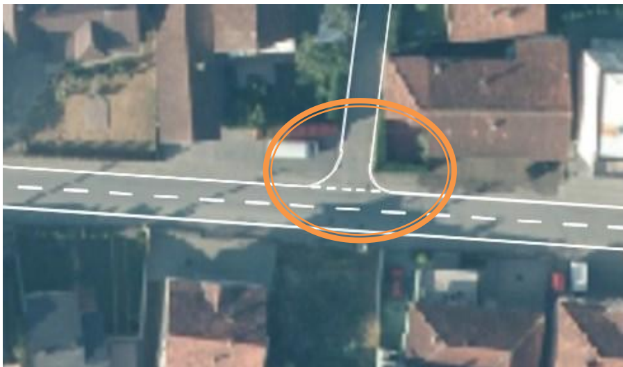
Figura 7.16: Gjendja ekzistuese e udhëkryqit të formës T në rrugën “Hasan Prishtina”
