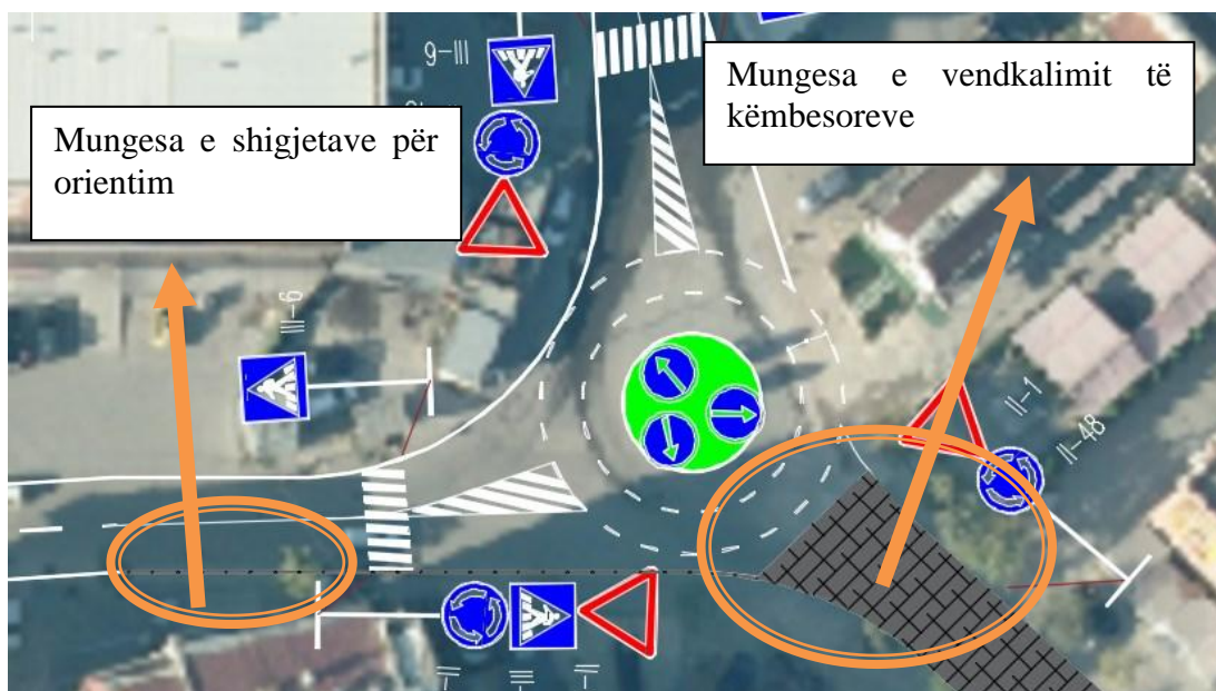
Figura 7.33: Mangësitë e vërejtura në udhëkryqin tek sheshi “Nënë Tereza”
