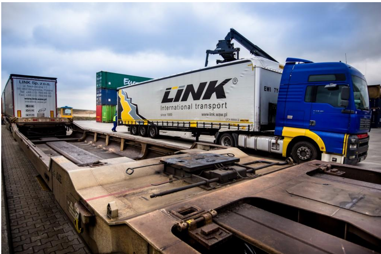
Në fig. 6.2. Është paraqitur përdorimi i teknologjisë Hucke pack (ngarkimi-shkarkimi me piruner)
