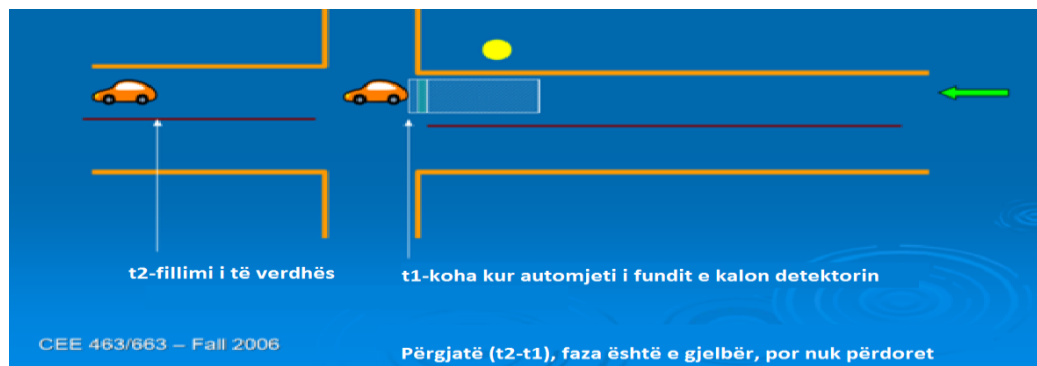
Fig. 2.7 Efekti I lokacionit të detektorit – vija STOP
