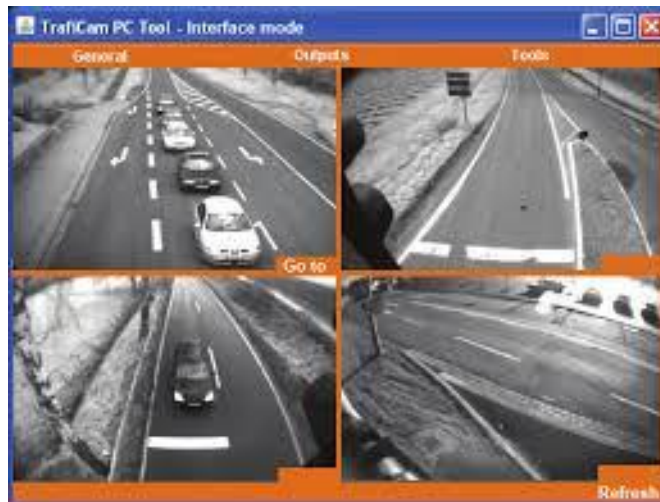
Fig. 3.8 Teknologjia e detektimit përmes video detektorëve 17
