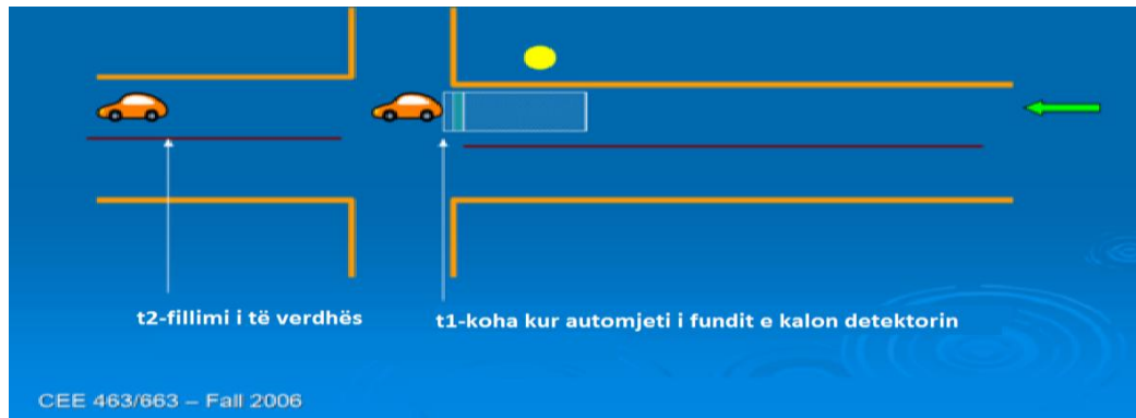
Fig. 2.8 Efekti I lokacionit të detektorit – e avancuar
