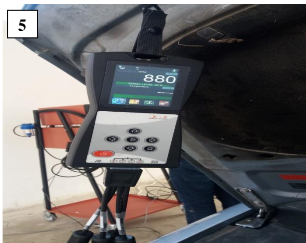
Figura 20. 1. Futja e të dhënave në paisjen caretec cet, 2. Proçesverbali me të dhënat e automjetit, 3. Lidhja e paisjes me tubin e shkarkimit të gazrave dalëse nga automjeti. 4. Lidhja e paisjes OBD për matjen e rpm dhe temperatures së vajit. 5. Rezultati i rpm nga paisja në marshin neutral. 6. Procesi i punës së paisjes cartec cet 2200c.
