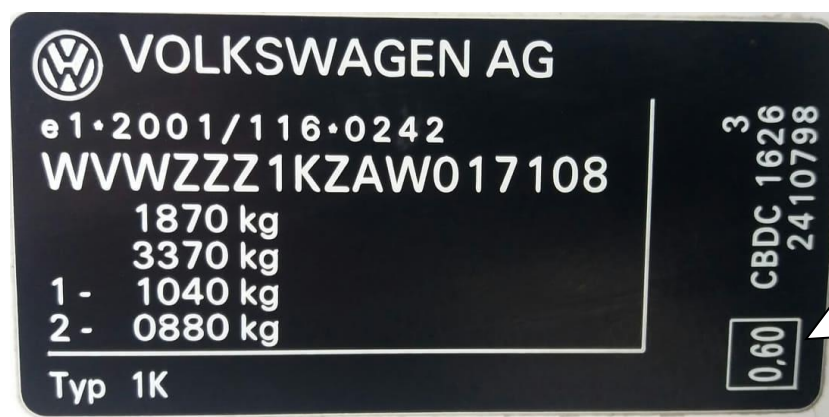
Figura 19. Paraqitja e tiketës së motorit, numri i shasis (vin numri) dhe vlera e parametratit “ k ” për ndotje të automjetet diezel.
