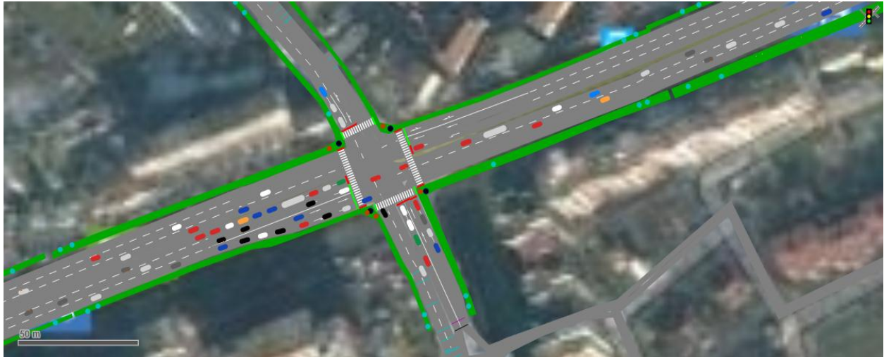
Figura 50. Forma 2D e udhëkryqit 2 të projektuar me PTV VISSIM 8.0.
