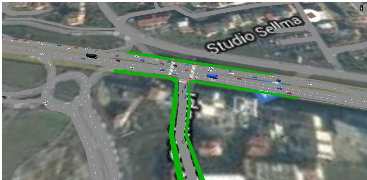
Figura 58. Forma 3D e udhëkryqit 3 të projektuar me PTV VISSIM 8.0.
