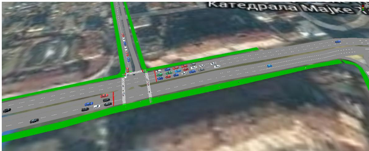
Figura 44. Forma 3D e udhëkryqit në formë 'T' e projektuar me PTV VISSIM 8.0.
