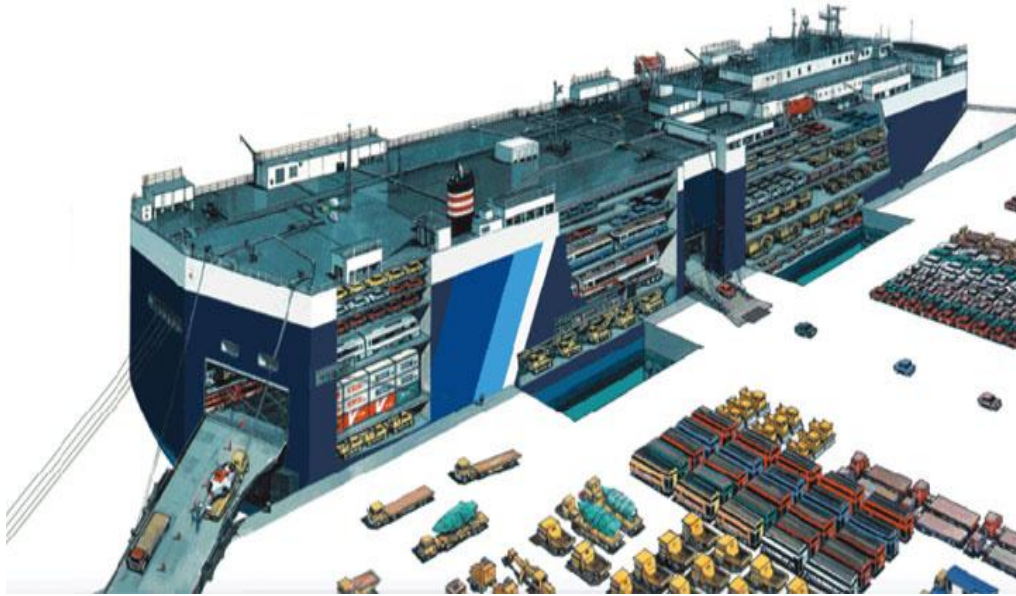
Figura 3. 12. Anija e kombinuar me teknologji Ro-Ro për transport të automjeteve rrugore dhe kontenjerëve [10].
