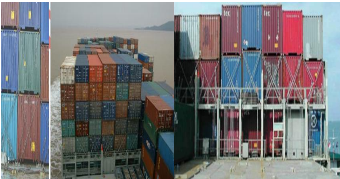
Figura 3. 21. Sistemi i përforcimit të kontejnerëve në anije [23].
