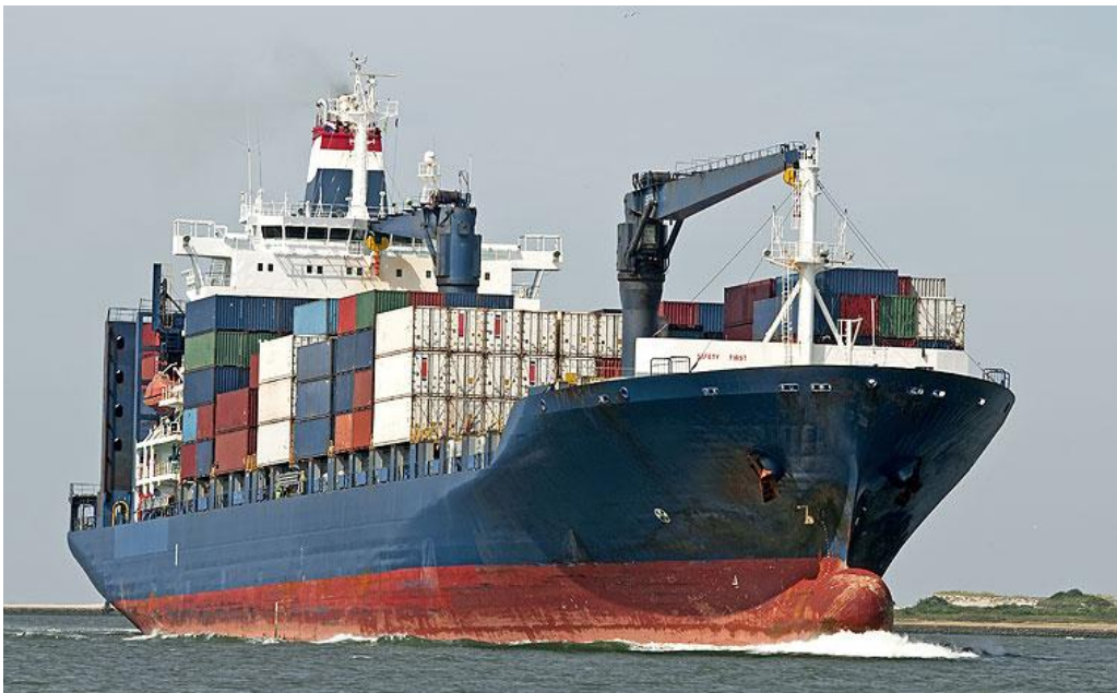
Figura 3. 10. Transporti i kontejnerëve në anije me anë të sistemit Lo-Lo me mekanizëm të vetë të ngarkimit [10].
