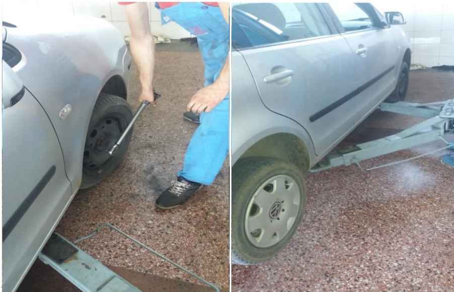
Figura 5.23. Lirimi i bulonave të rrotës dhe ngritja e automjetit me lift
