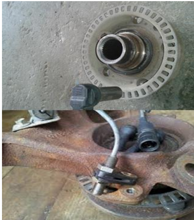
Figura 4.4. Mënyra e kontrollimit të shpejtësisë rrotulluese dhe bllokimit të rrotave të automjetit
