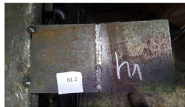
Hapi i parë i saldimit me elektrodë rutile 2.5mm
