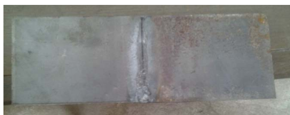
Fig.5.22. Mbushja e pamjaftueshme e pllakave te salduara
