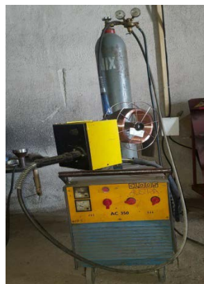
Fig.2.4. Aparati për saldim nën mbrojtjen e gazit inert MIG-MAG.
