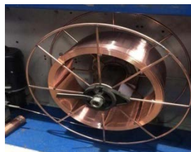
Fig.2.5. Materiali plotësues-teli për saldim MIG-MAG.
