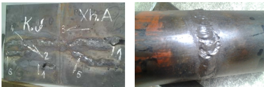
Fig.5.20. Plasaritjet,zbrazëtitë dhe djegiet ne tegelin e salduar gjatë kontrolës vizuale në laboratorin e FIM
