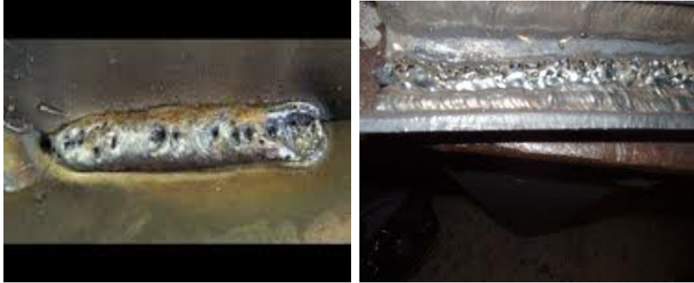
Fig.5.15. a) zbrazëti në tegelin e salduar dhe b) poret në bashkësinë e salduar
