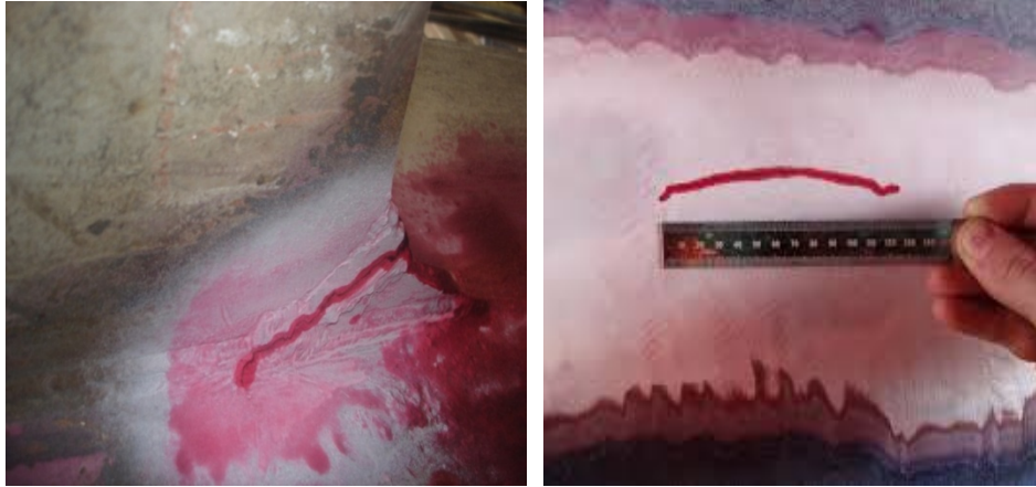
Fig.5.11. Prova me penetrant (lëng kapilar) dhe matja e gabimit
