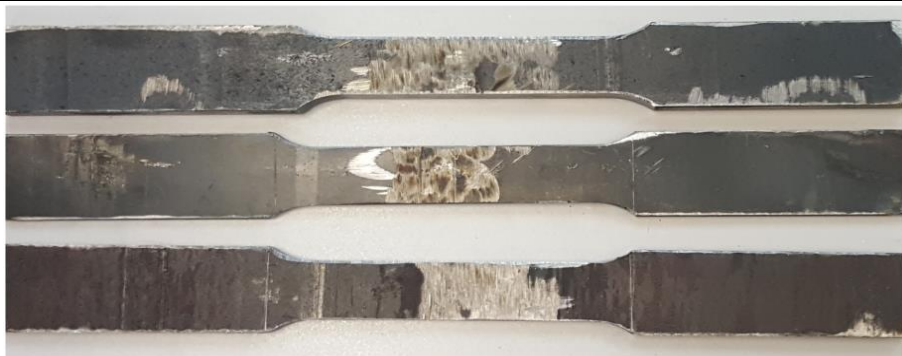
Kampionët standard për provën e tërheqjes së bashkësisë së salduar me tegel ballor
