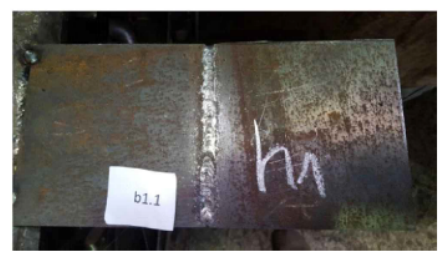
Hapi i parë i saldimit me elektrodë rutile 2.5mm
