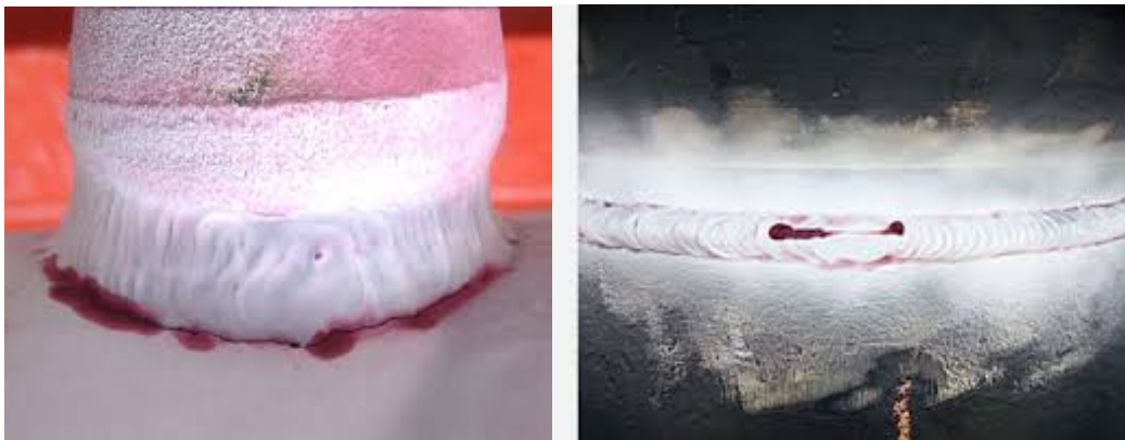
Fig.5.12. Zbulimi i plasaritjeve te tegelit te salduar të gypave me metodën penetruese
