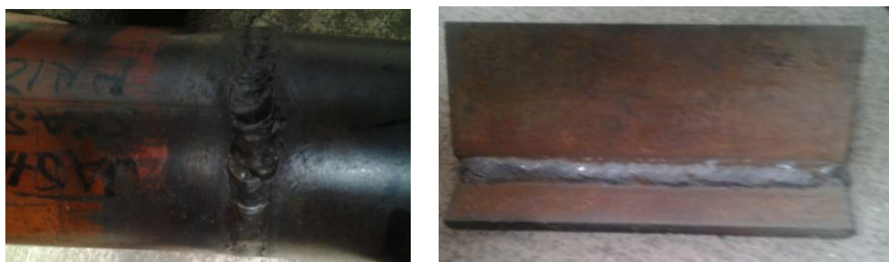
Fig.5.21. Mbilartësia e teglit te salduar te pllakave dhe gypit gjatë kontrollës vizuale në laboratorin e FIM.
