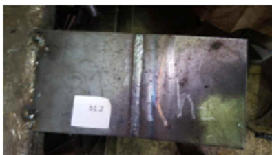
Hapi i dytë i saldimit me elektrodë rutile 4.0mm
