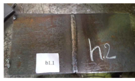
Hapi i dytë i saldimit me elektrodë rutile 3.25mm
