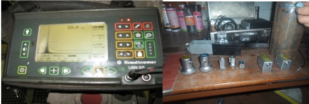
Fig.5.9.Dhe aparati KRAUTKRAMER USN 52L për provën me ultratingull dhe sondat e ultratingulli (kokat)
