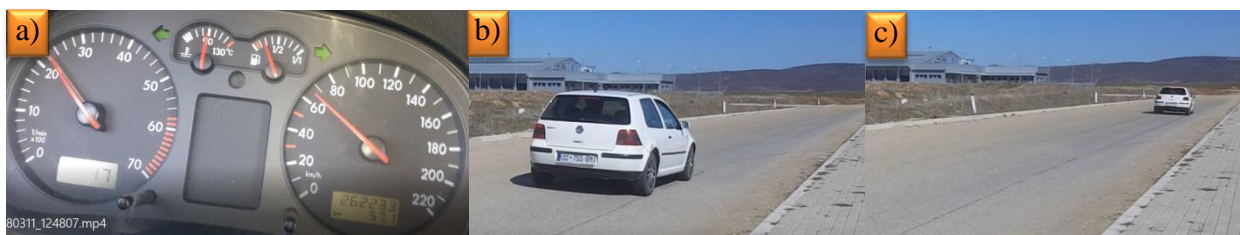
Fig. 5.7. a) Shpejtësia e lëvizjes së automjetit 64 km/h, b) pozicioni fillestar gjatë procesit të frenimit, dhe c) pozicioni përfundimtar i automjetit gjatë procesit të frenimit.
