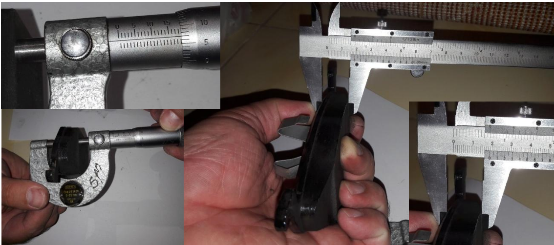
Fig. 7.2. Paraqitja e matjes së shkallës së konsumit për pllakat frenuese (ferodat) e prodhuesit BREMBO pas përfundimit procesit të testimit. Matja e trashësisë është bërë me mikrometër dhe nonjus për arsye të vërtetimit të saktësisë.
