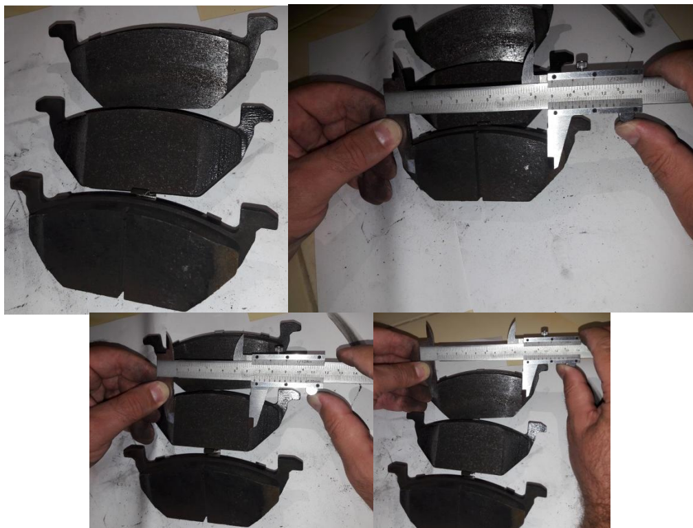
Fig. 7.4 Paraqitja e matjes së sipërfaqes kontaktuese të secilit prodhues të pllakave frenuese
