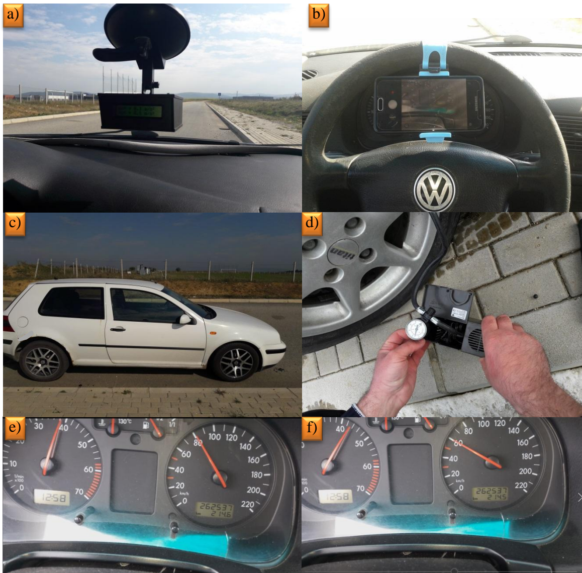
Fig.4.11. Paraqitja e fazës fillestare dhe përfundimtare të testimit a) Montimi i XL METER, b) vendosja e video aparatit, c)shikimi vizual i automjeti, d) matja e presionit të pneumatikëve, e) ngasja me shpejtësi prej 80 km/h dhe f) ngasja me shpejtësi prej 60 km/h.
