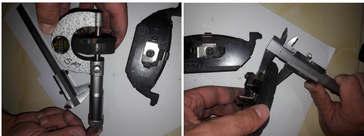
Fig. 7.1. Paraqitja e matjes së shkallës së konsumit për pllakat frenuese (ferodat) e prodhuesit SCT pas përfundimit procesit të testimit. Matja e trashësisë është bërë me mikrometër dhe nonjus për arsye të vërtetimit të saktësisë.
