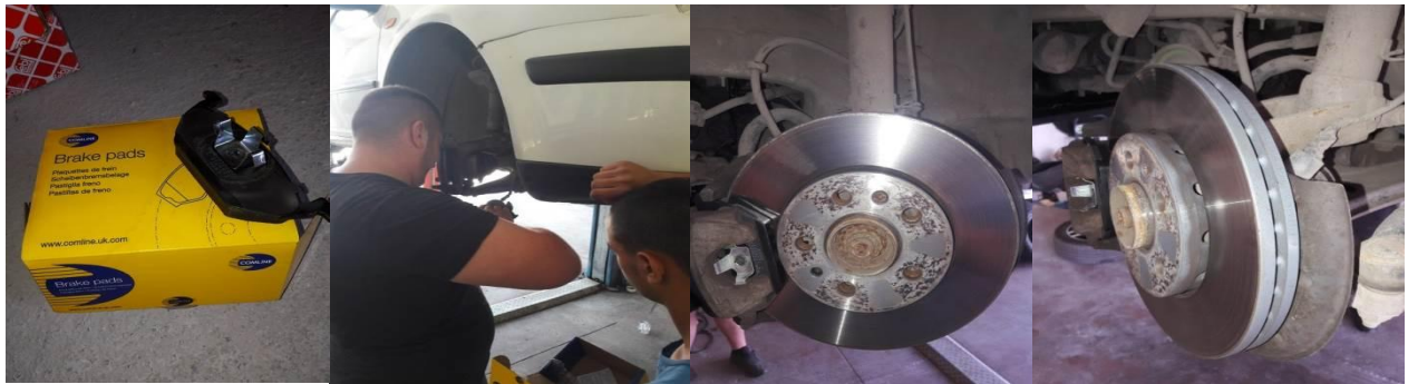
Fig. 5.60. Paraqitja e montimit të ferodave nga prodhuesi COMLINE dhe përgatitja për testim
