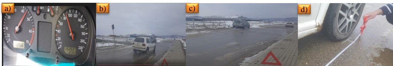
Fig. 5.18. a) Shpejtësia e lëvizjes së automjetit 83 km/h, b) pozicioni fillestar gjatë procesit të frenimit, dhe c) pozicioni përfundimtar i automjetit gjatë procesit të frenimit, d) matja e gjatësisë së gjurmës së frenimit.
