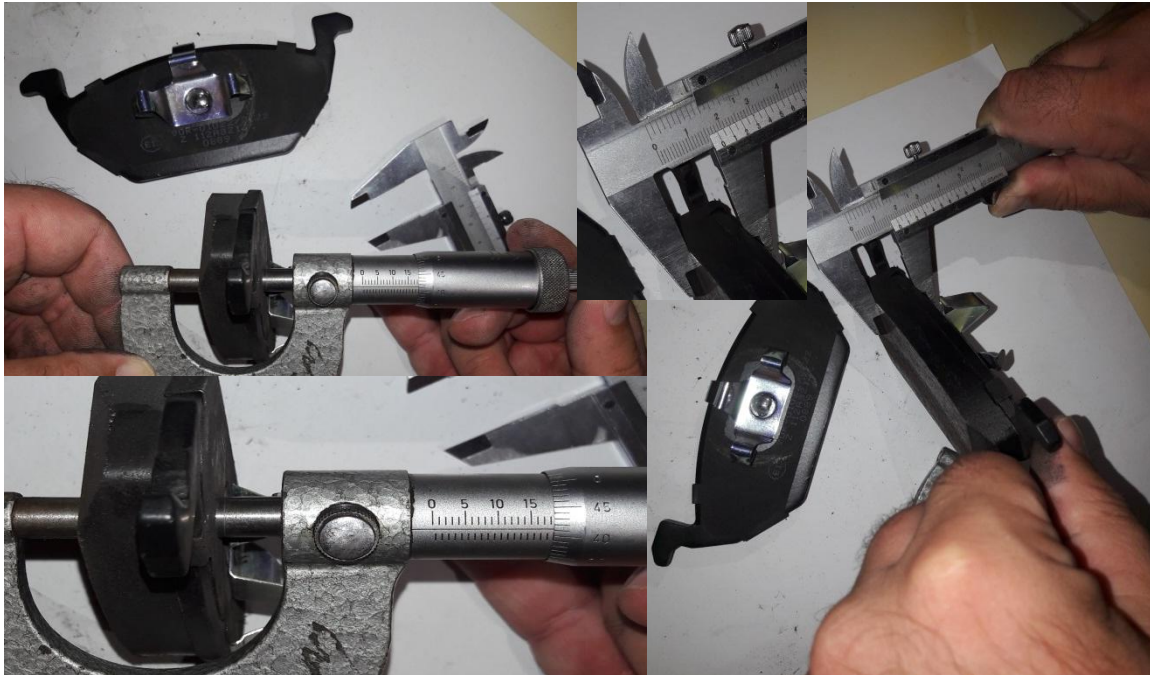
Fig. 7.3. Paraqitja e matjes së shkallës së konsumit për pllakat frenuese (ferodat) e prodhuesit COMLINE pas përfundimit procesit të testimit. Matja e trashësisë është bërë me mikrometër dhe nonjus për arsye të vërtetimit të saktësisë.
