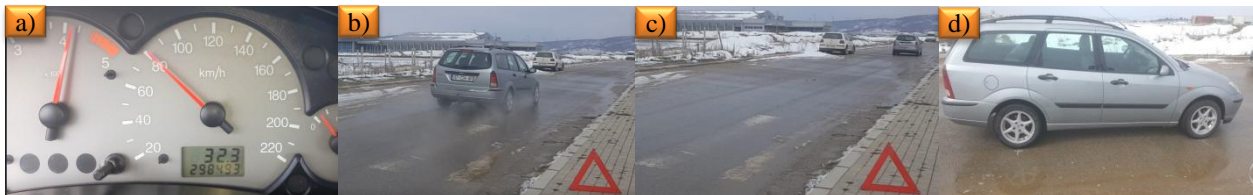
Fig. 5.24. a) Shpejtësia e lëvizjes së automjetit 81 km/h, b) pozicioni fillestar gjatë procesit të frenimit, dhe c) pozicioni përfundimtar i automjetit gjatë procesit të frenimit, d) matja e gjatësisë së gjurmës së frenimit.
