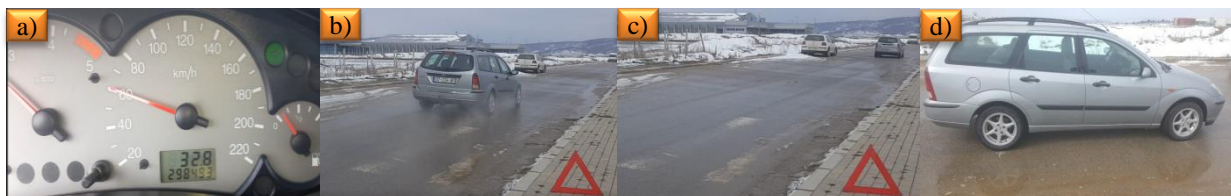
Fig. 5.27. a) Shpejtësia e lëvizjes së automjetit 61 km/h, b) pozicioni fillestar gjatë procesit të frenimit, dhe c) pozicioni përfundimtar i automjetit gjatë procesit të frenimit, d) matja e gjatësisë së gjurmës së frenimit.
