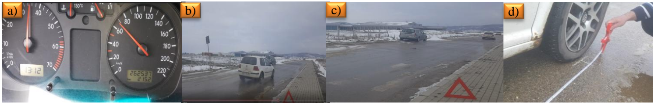
Fig. 5.21. a) Shpejtësia e lëvizjes së automjetit 65 km/h, b) pozicioni fillestar gjatë procesit të frenimit, dhe c) pozicioni përfundimtar i automjetit gjatë procesit të frenimit, d) matja e gjatësisë së gjurmës së frenimit.
