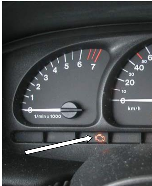
Fig. 6.12. Lampa paralajmëruese në tabelën e instrumenteve të automjetit [2].
