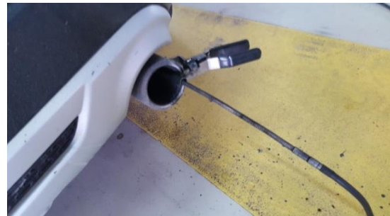
Fig. 7.17. Vendosja e sondës së paisjes hulumtuese në gypin e gazrave dalëse të automjetit Volvo.
