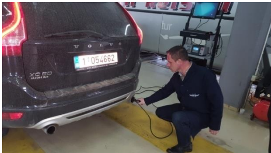
Fig. 7.17. Vendosja e sondës së paisjes hulumtuese në gypin e gazrave dalëse të automjetit Volvo.
