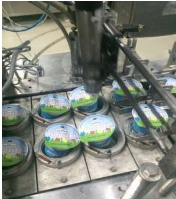
Fig.5.15. Vendosija e datës së prodhimit dhe skadimit, përmes laserit.
