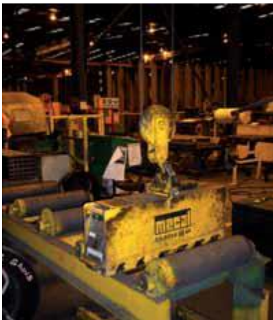
Fig.3.8. Vinçi për transport të produkteve në makinerit e rënda
