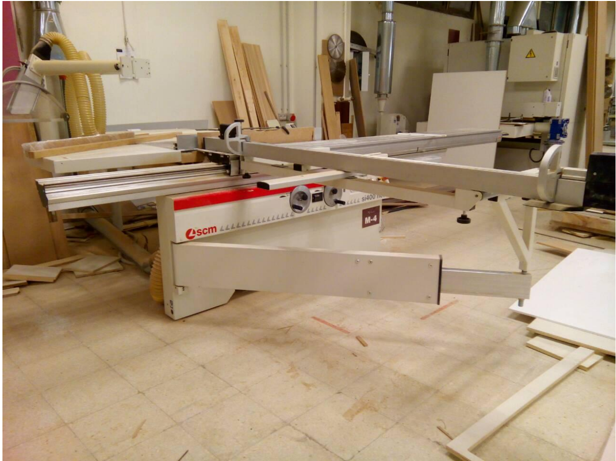
Fig.4.7. Sharra për prerje manuale si 400 nova (scm si 400)
