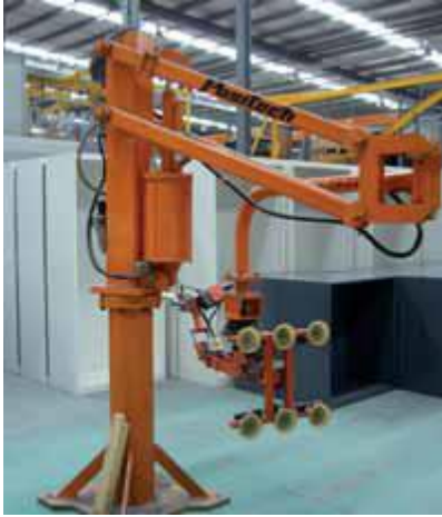
Fig.3.9. Manipulatori përdoret për të transportuar produkt në një tjetër vendpunim.
