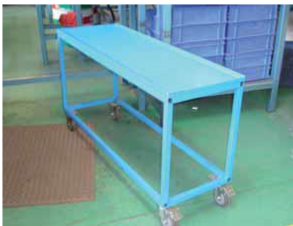
Fig. 3.6.Karroçë e cila përdoret për transportimin e materialeve.
