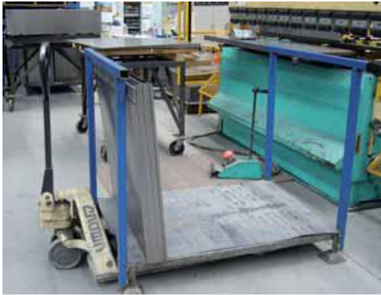
Fig. 3.7. Pirunjeri i dores i cili ndihmon në lëvizjen e produktit
