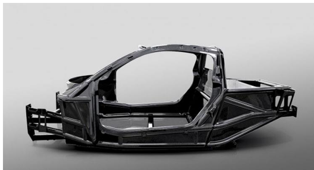
Figura 5.8. Shasia e automjeteve sportive Yamaha, me materiale kompozite me fibra karboni [21]
