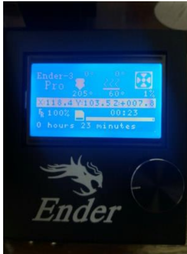
Figura 7.4. Koordinatat, temperatura e punës dhe koha e nevojshme për përfundimin e modelit në printerin 3D
