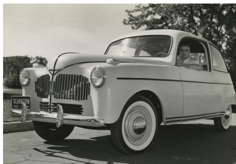
Figura 5.2. Automjeti Ford me materiale kompozite me matricë duromere [17]
