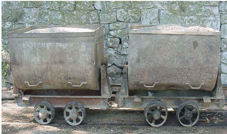
Figura 6.1: Vagonët e mbushur me rërë për provë
