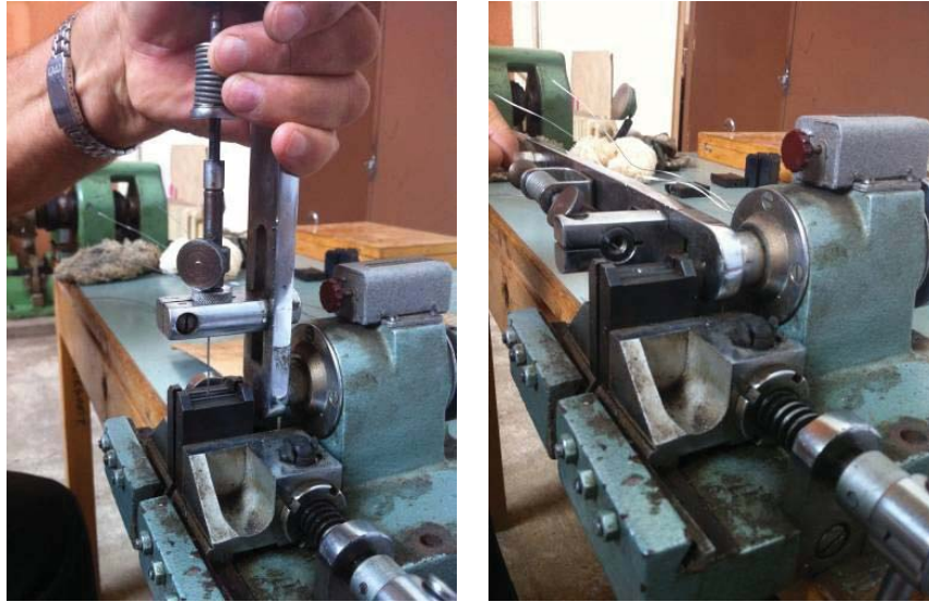
Figura 5.8: Pajisja për provën e përkuljes së shumëfishtë
