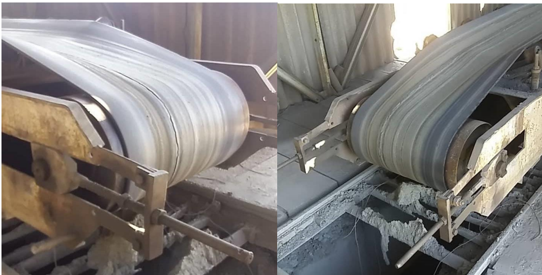
Fig.7.5. Mekanizmi i shtrëngimit të shiritit
