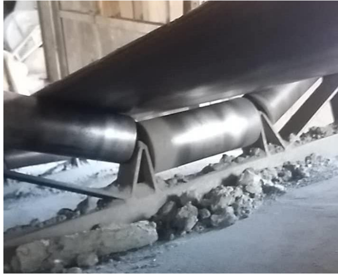
Fig. 7.2. Seksioni tërthor i mbushjes, në formë korite
