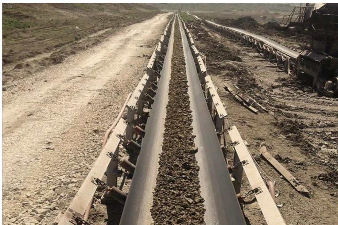
Fig. 2.3 Transporti i jashtëm ( prej basenit të thëngjillit deri te depoja kryesore në termocentral )
