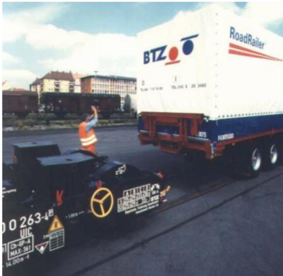
Figura.7.1. Teknologjia bimodale: a) Bashkëngjitja e makinës udhëtuese në kuadër të boshtit; b) treni përbërës
