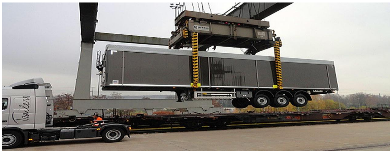
Figura.3.3 Mënyra e ngarkim-shkarkimit të teknologjisë Hucke Pack.
