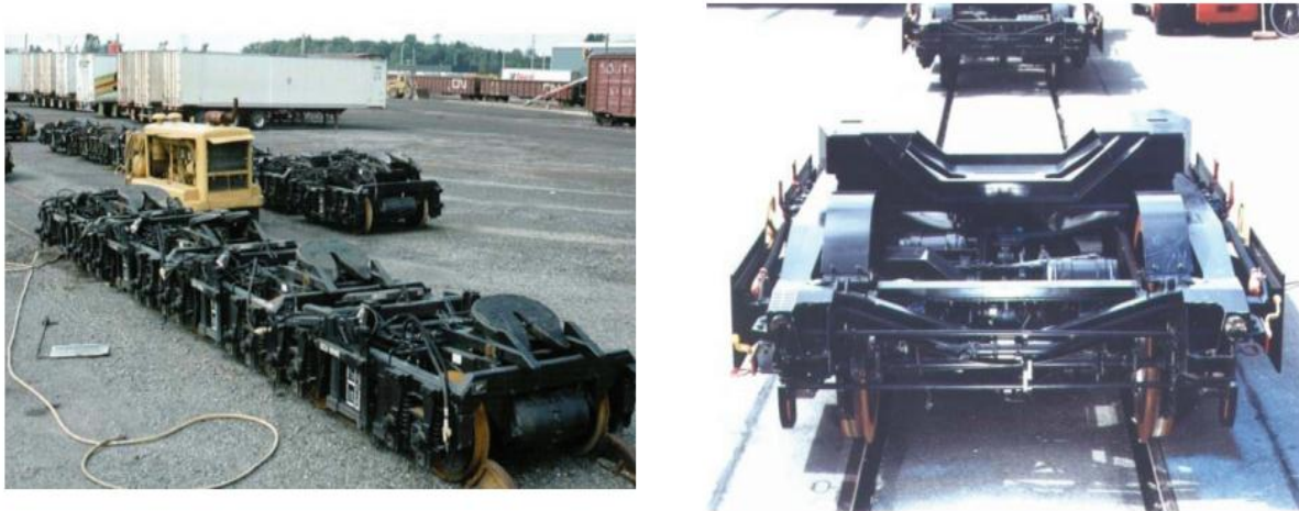
Figura.7.2. Grupet boshtore hekurudhore për bashkëngjitje të makinave udhëtuese
