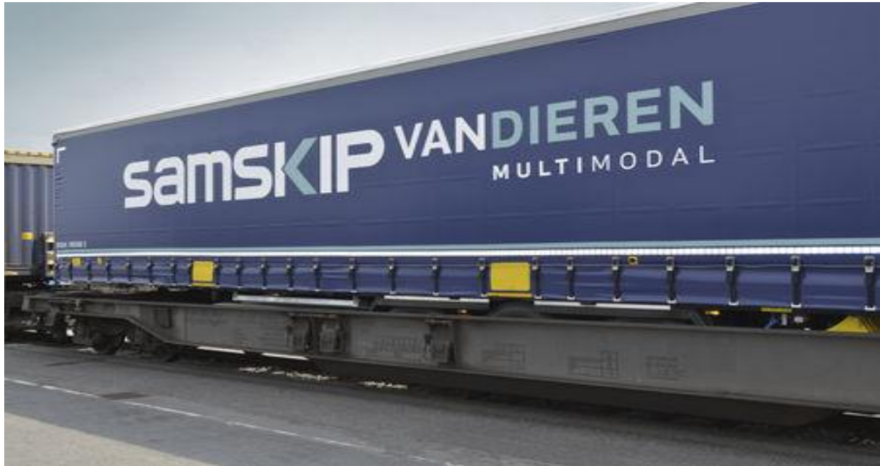
Fig.3.1. Huckepack teknologjia – Transporti i mjeteve rrugore me vagona hekurudhor
