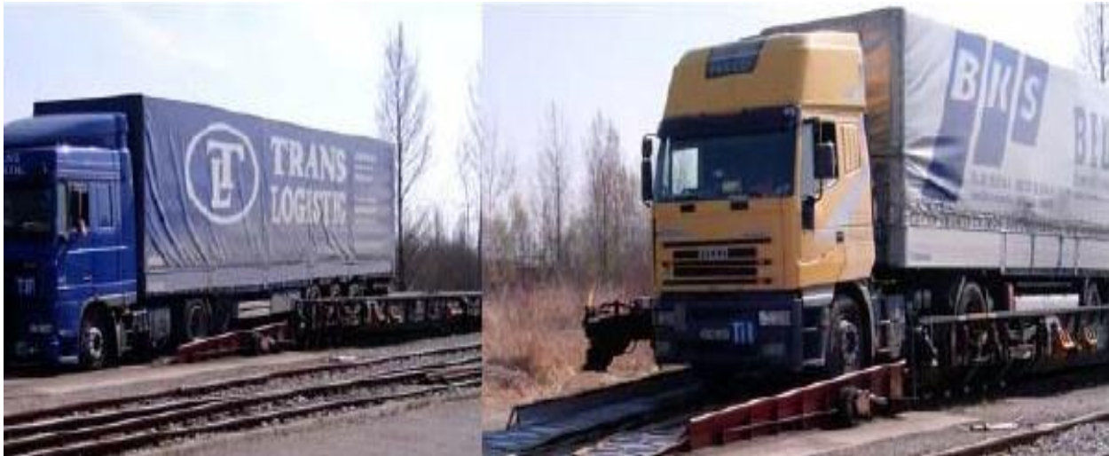
Fig.5.2. Mënyra horizontale e ngarkimit (përmes rampave)
