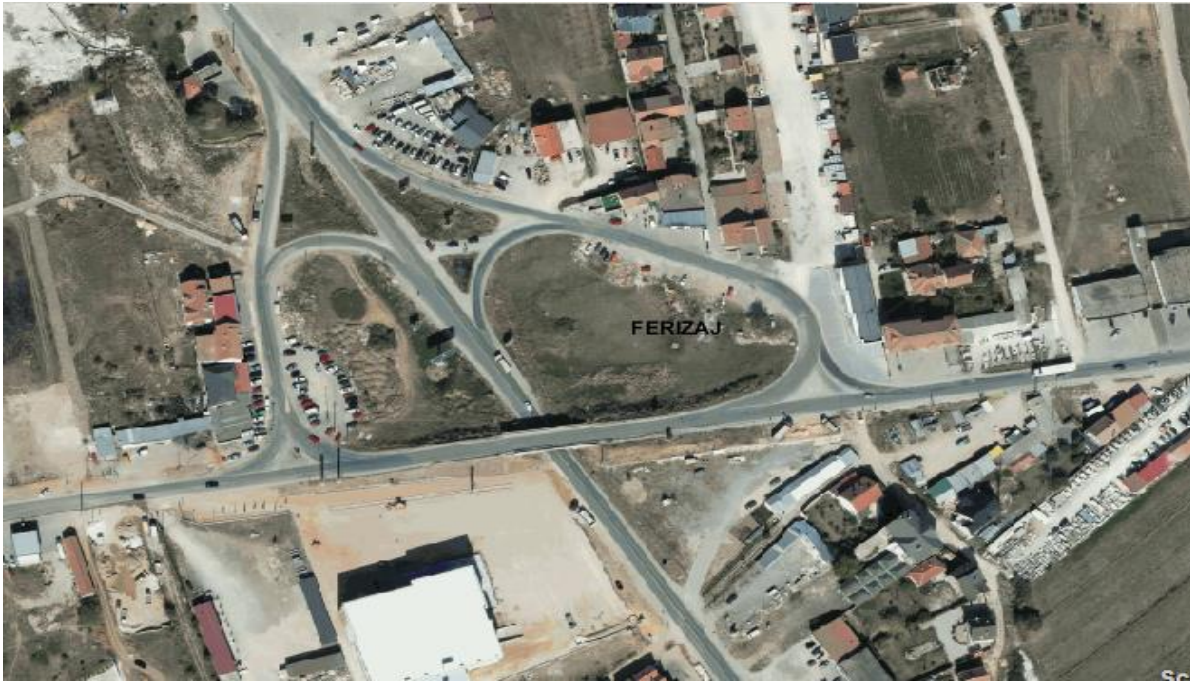
Figura 2.13. Udhekryqi ne disnivel ne rrugen magjistrale M2 ne hyrje te qytetit te Ferizajit.
