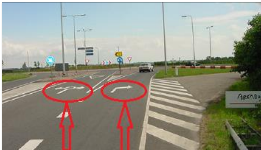
Figura 3.7. Ilustrimi i sinjalizimit horizontal në hyrje të rrethrotullimit.
