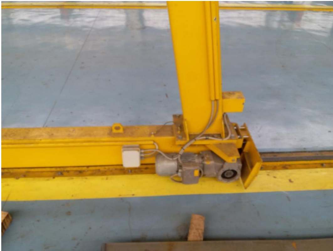
Fig. 5. Lidhja e vinçit gjysmëportal me dyshemenë.
