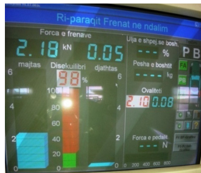
Fig. 4.3. Diferenca e forcave të frenimit në rrotat e boshtit/aksit të përparëm
