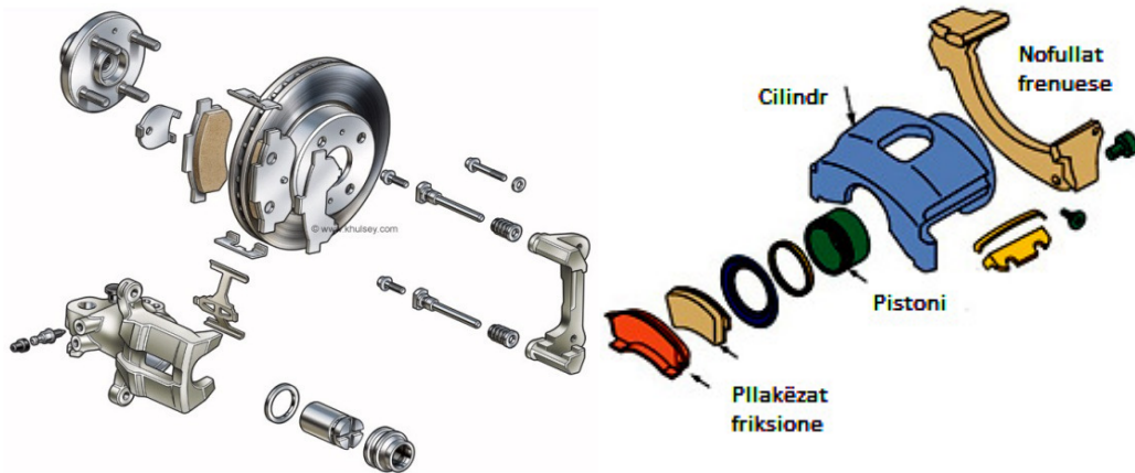
Fig. 3.18. Pjesët përbërëse të cilindrit frenues të rrotës.[15]
