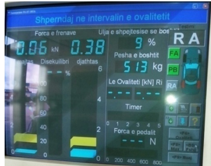
Fig. 4. 2. Forca e rezistencës në rrokullisje e paraqitur në monitor
