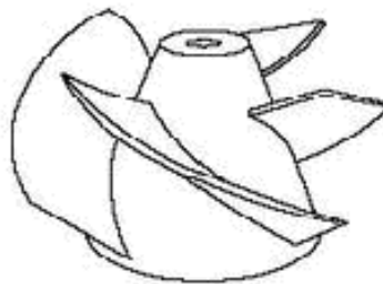
Fig. 1.10. Shtytës i pompave të ujit të ftohjes në TC "Kosova B"
