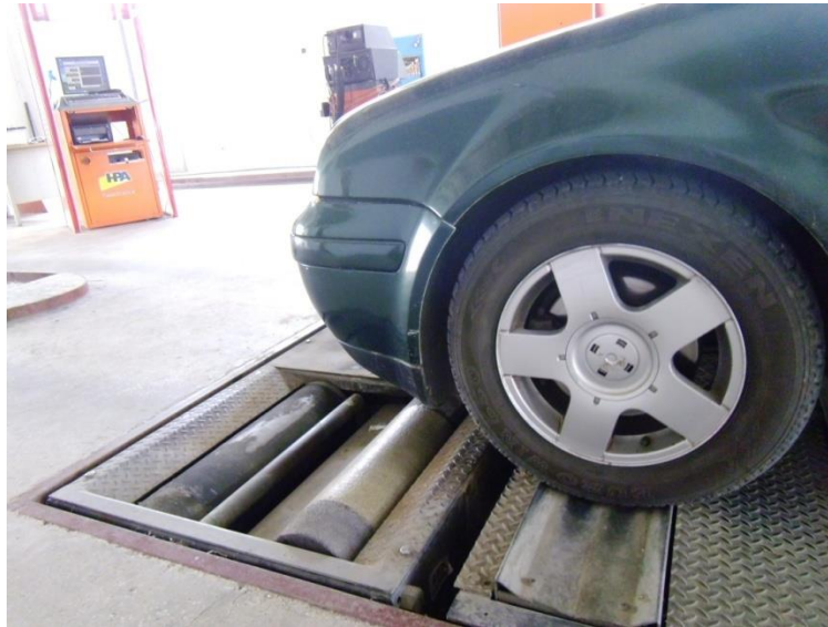
Figura 6.5: Sistemi HPA-FAIP e përdorur për testim
