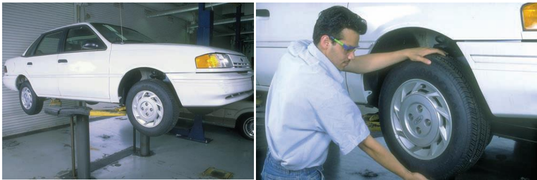
Figura 4.5: Ngritja e automjetit nga dyshemeja dhe kontrollimi i kushinetave [24]
