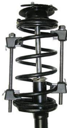
Figura 5.6: Pajisja për demontim/montim të sustave spirale
