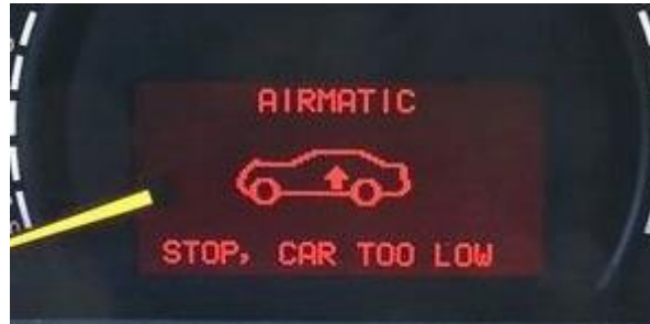
Figura 3.19: Shenja paralajmëruese e paraqitur në displej në rast të parregullsive në sistemin e mbështetjes
