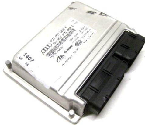
Figura 3.21: Njësia elektronike komanduese e sistemit të mbështetjes
