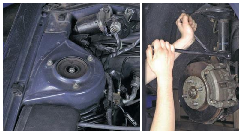
Figura 4.6: Kontrollimi nëse bulonat janë dëmtuar ose liruar
