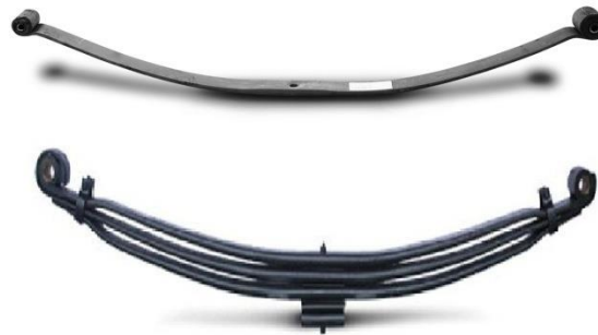
Figura 3.5: Susta me fletë parabolike me një ose me tri fletë [12]
