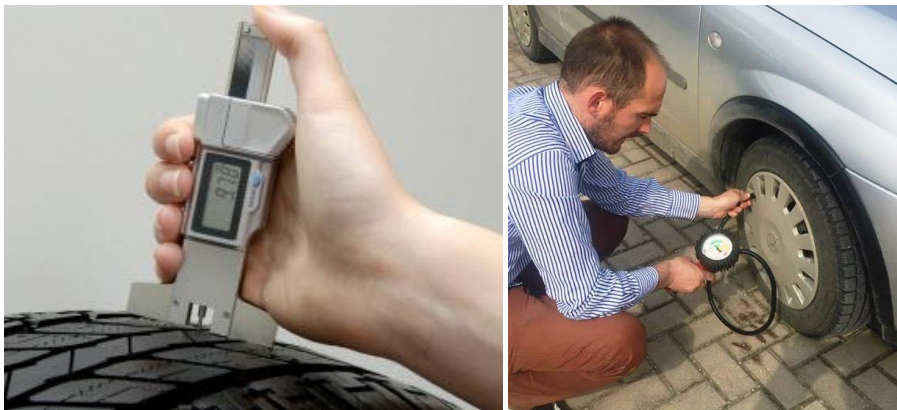
Figura 4.3: Kontrollimi i kanaleve të gomës [24] dhe matja e presionit të ajrit
