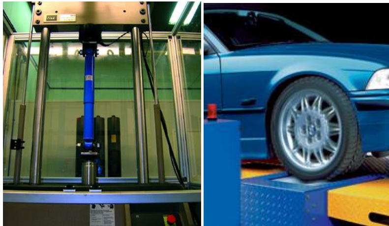
Figura 4.18: Testimi i amortizatorit me anë të pajisjeve të ndryshme
