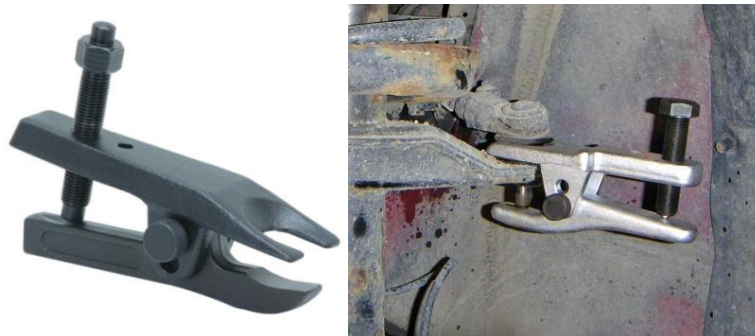
Figura 5.8: Pajisja për largimin e nyjeve sferike dhe elementeve prej gome
