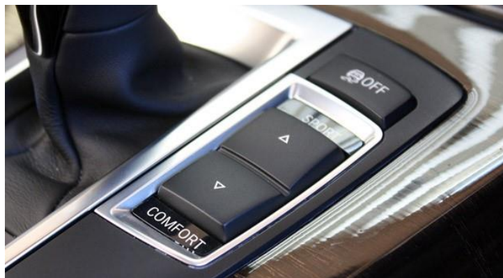
Figura 3.22: Tasti për kontrollimin dhe rregullimin e sistemit pneumatik të mbështetjes
