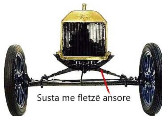
Figura 2.5: Sistemi i mbështetjes me sustë nga Henry Ford [5]
