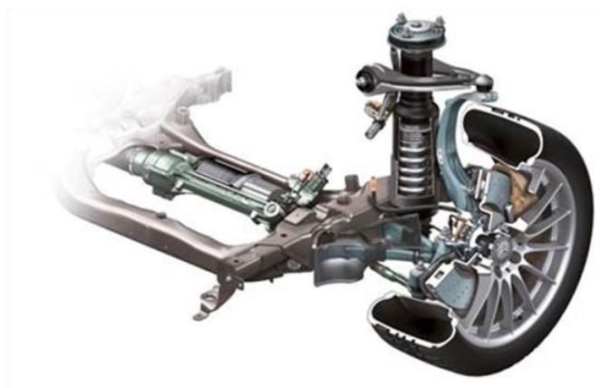
Figura 2.12: Sistemi aktiv i mbështetjes [7]
