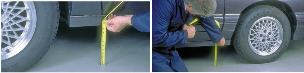
Figura 4.4: Kontrollimi i lartësisë së automjetit [24]
