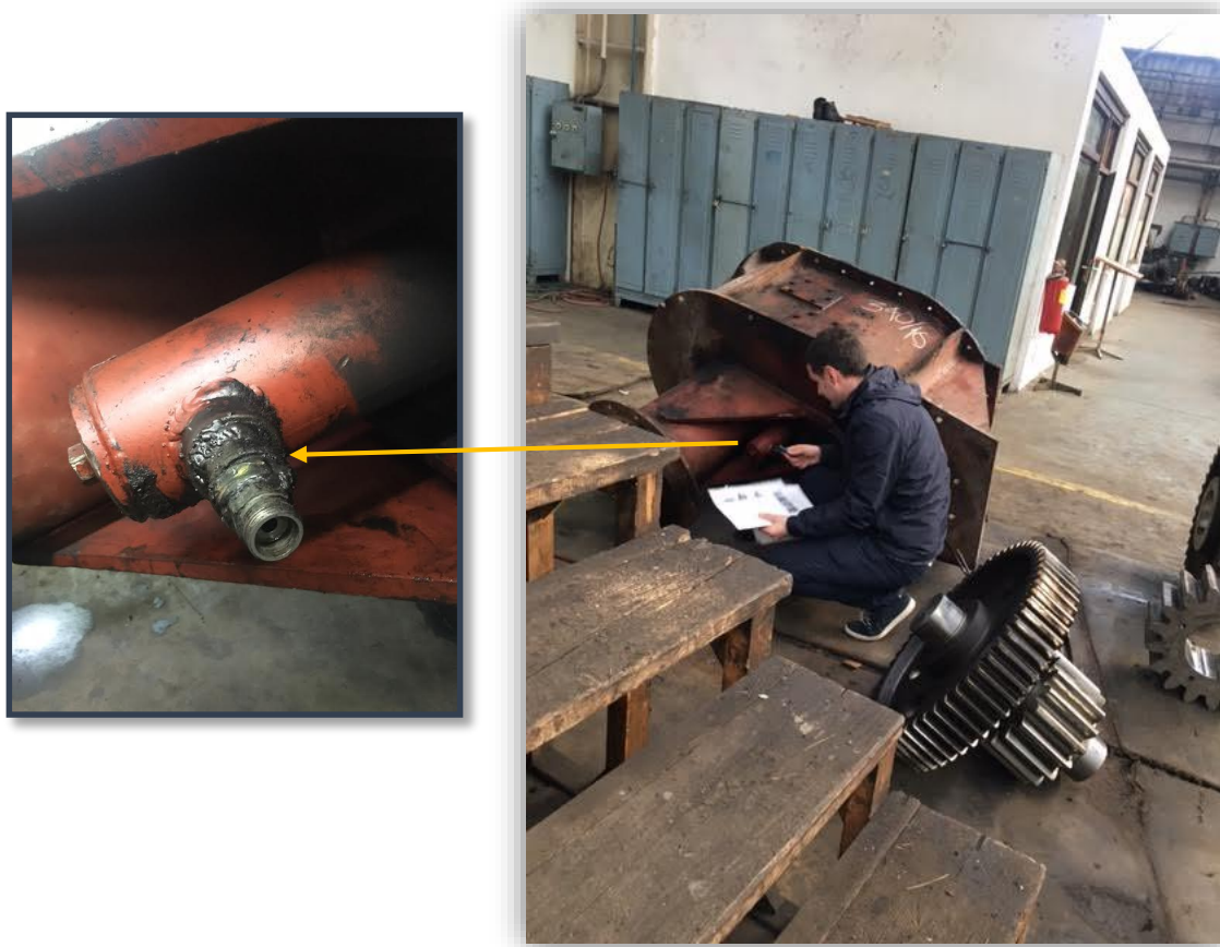
Fig. 7.5. Gypi i furnizimit me lyerës për kushinetën rrëshqitëse radiale, tek shtëpiza e reduktorit [6].
