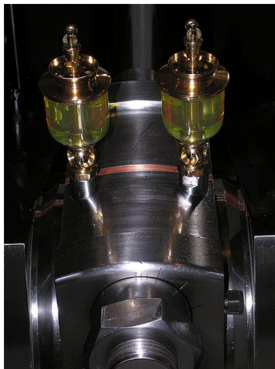
Fig. 5.4. Njëra nga mënyrat e thjeshta të lyerjes tek kushinetat rrëshqitëse radiale [49].
