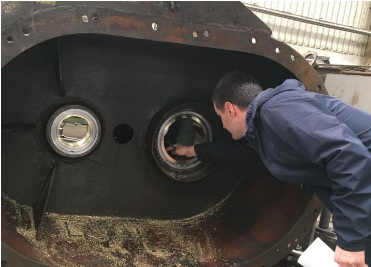
Fig. 7.7. Inspektimi i përpunimit të sipërfaqeve të brendshme të unazave të kushinetave [6].
