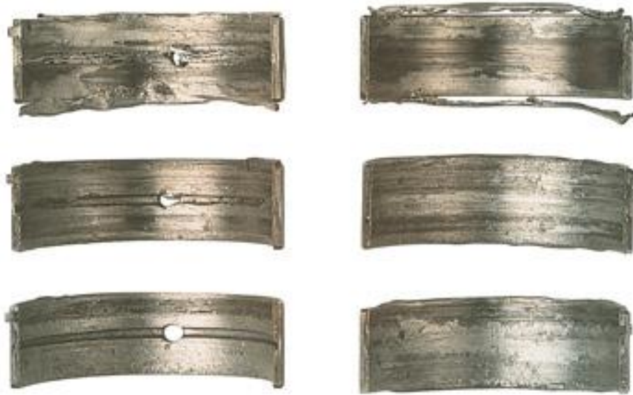
Fig. 4.11. Dëmtimi kushinetës rrëshqitëse radiale për shkak të mbingarkimit [43].
