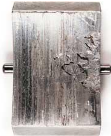
Fig. 4.0. Dëmtimi i unazës segmentale të kushinetës rrëshqitëse radiale [33].
