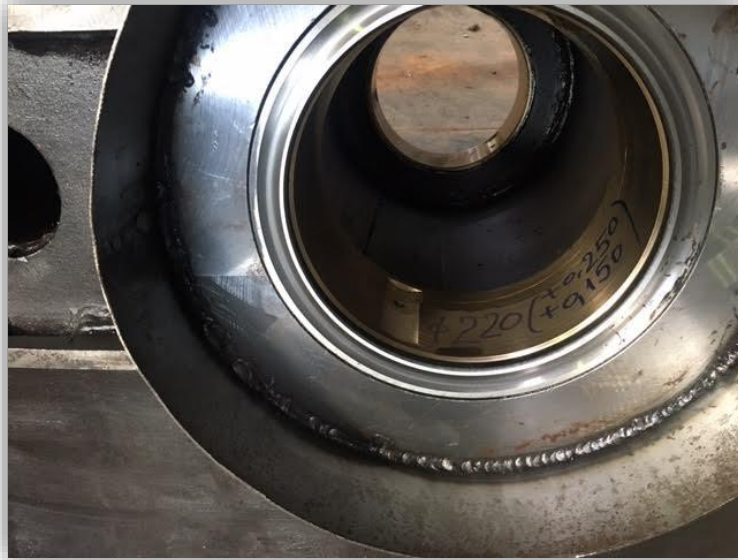
Fig. 7.3. Kushinetat rrëshqitëse radiale të montuara në shtëpizën e reduktorit [6].
