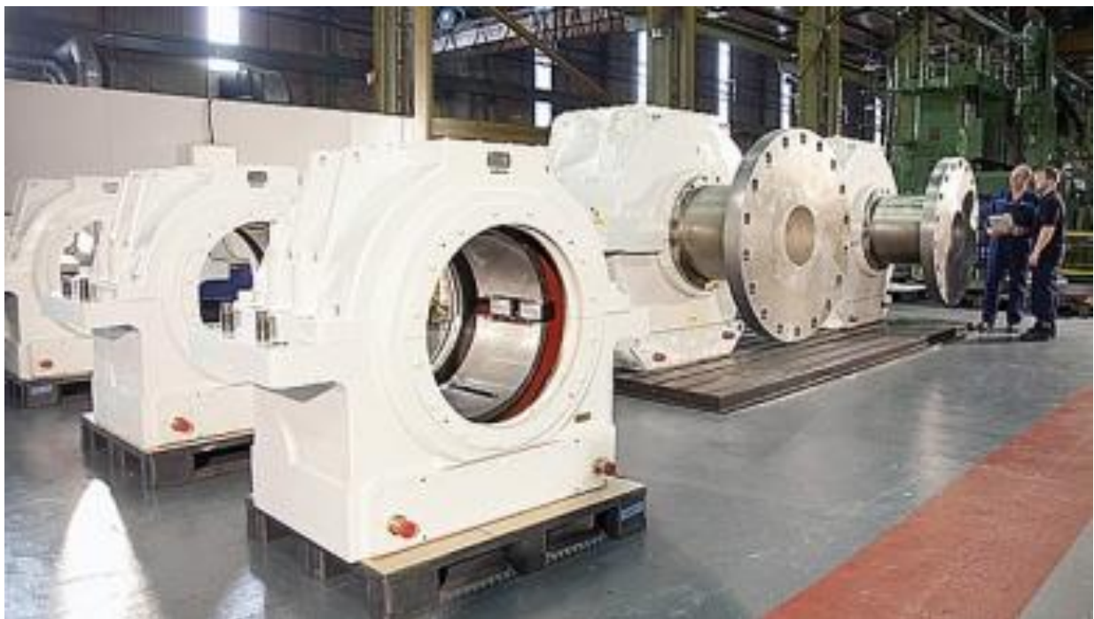
Fig. 2.6. Kushinetë rrëshqitëse radiale me dimensione të mëdha [11].
