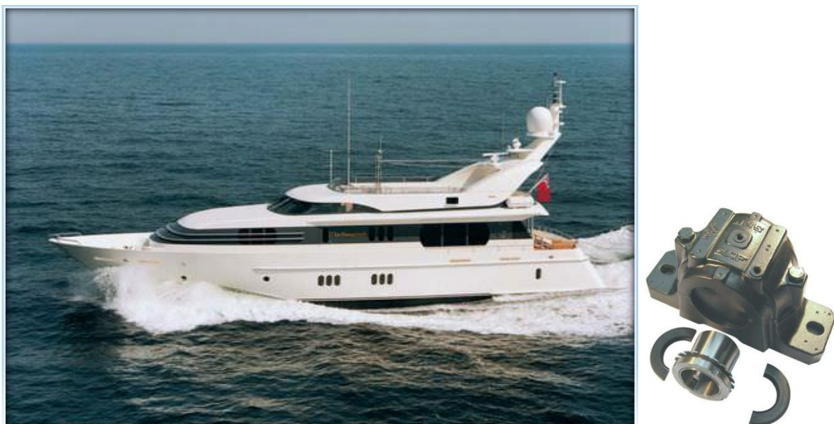
Fig. 2.4. Jaht luksoz, i cili përdorë kushineta rrëshqitëse radiale të prodhuesit SKF tek helika [9].
