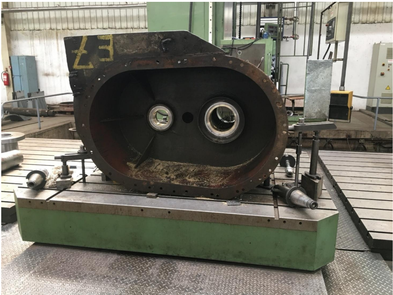
Fig. 7.6. Shtëpiza e reduktorit e vendosur në makinën frezuese, për përpunimin e unazave të kushinetave rrëshqitëse radiale [6].
