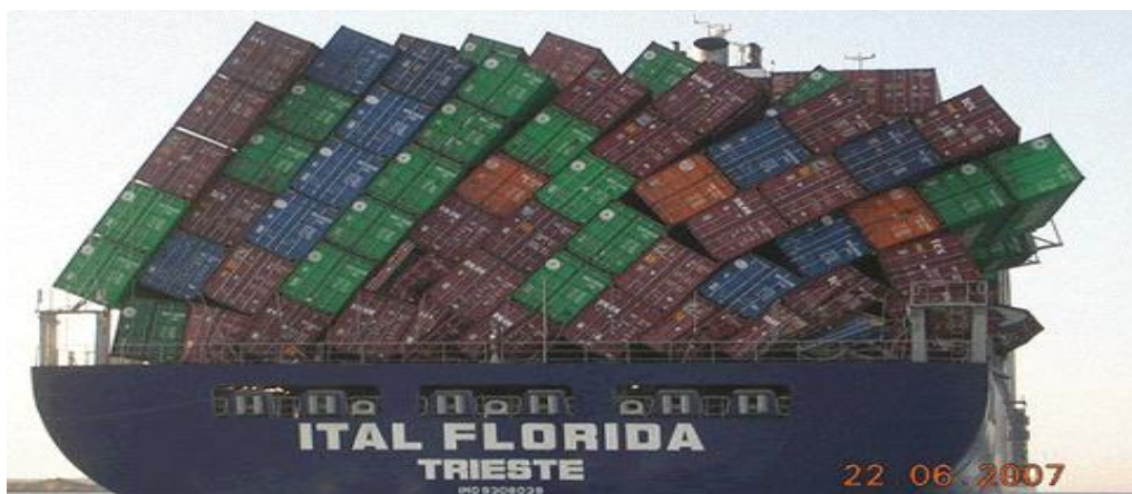
Figura 3.34. Efekti negativ nga sigurimi i keq i kontejnerëve të ngarkuar [4].
