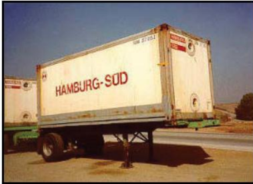
Figura 3.9. Kontejner ftohës i cili shfrytëzon pajisje për ftohje [4].
