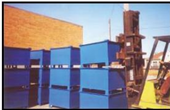
Figura 3.18. Manipulimi me kontejnerë të vegjël me mekanizëm standard të mbingarkimit (me forklift) [4].
