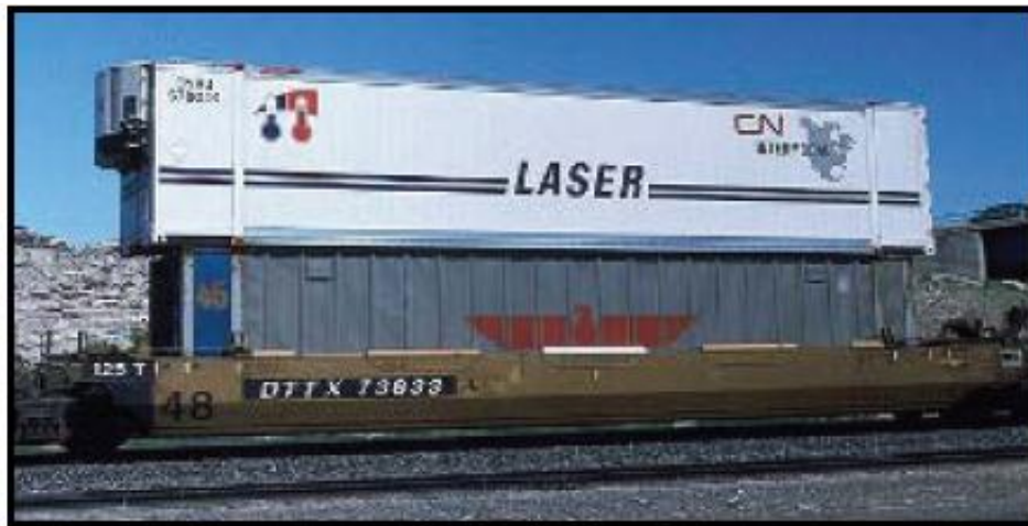
Figura 3.11. Kontejner me gjenerator dhe me pajisje për ftohje dhe ngrohje [4].
