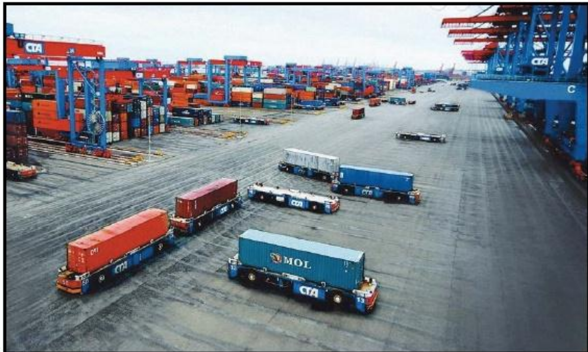
Figura 4.10. Mjete automatike për ujë AGVS [3].
