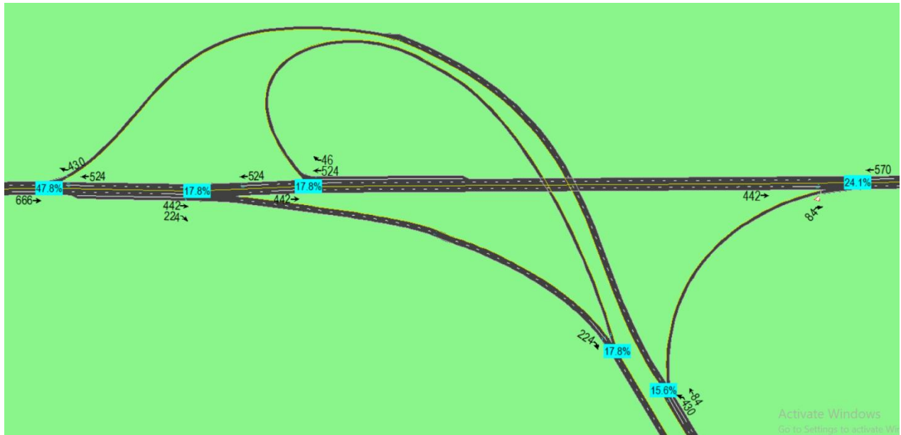
Fig.7.3 Shkalla e shfrytëzimit të udhëkryqit në disnivel
