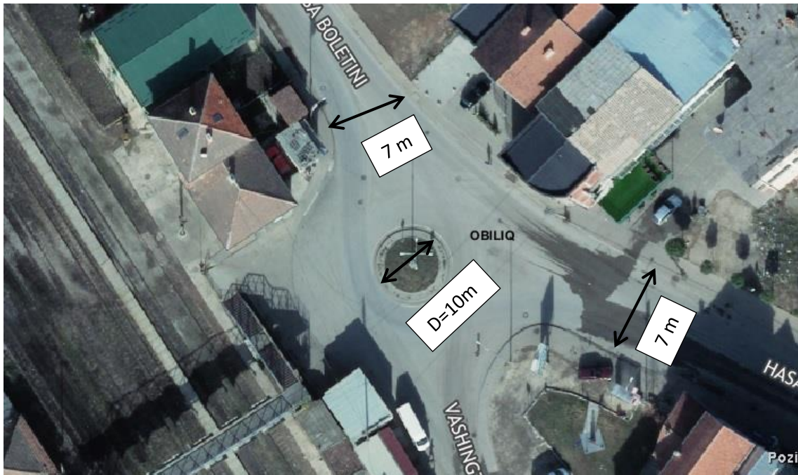
Fig.2.15. Dimenzionet e rrethrotullimit tredegësh në dalje të Obiliqit
