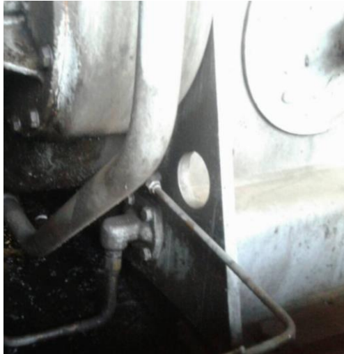
Figura 3.58: Shkarkimi i llumit në mënyrë automatike
