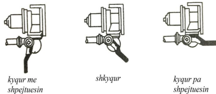
Figura 3.18: Rubineti shkyçës i frenave me veprim të shpejtë Westinghouse dhe Knorr
