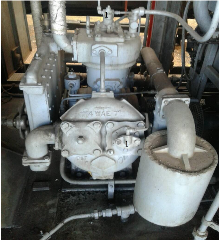
Figura 3.54: Kompresori i montuar në lokomotivë, 1- valvula e shkarkimit të kompresorit
