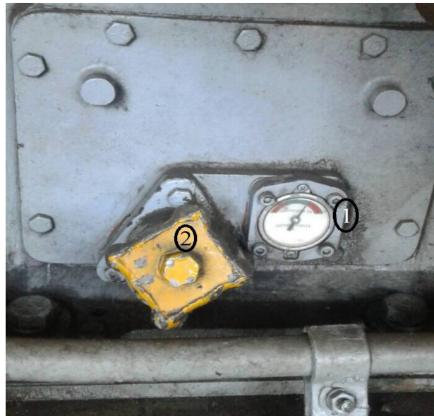
Figura 3.55: 1- treguesi i mbushjes me vaj për lubrifikimin e kompresorit, 2- vrima për shtimin e vajit për lubrifikim në kompresor
