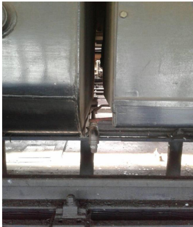
Figura 3.57: Rubineti për shkarkimin e rezervuarit të ajrit
