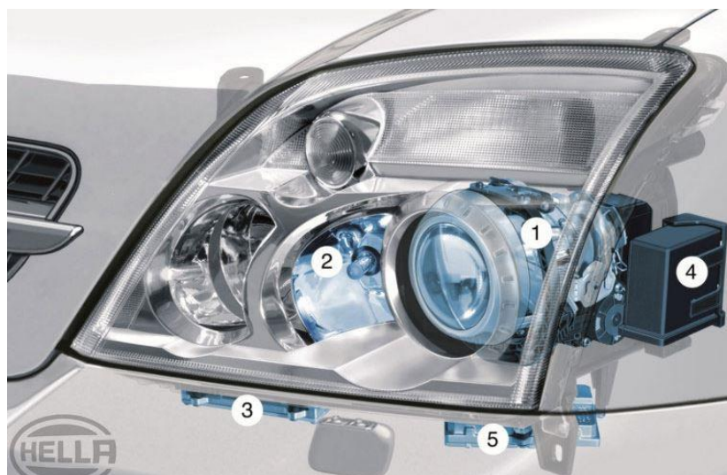
Figura 49. Llamba e Opel Signum-it: 1 Moduli lëvizës (Bi-Xenon), 2 Dritat këndore, 3 Moduli i prodhimit të dritës, 4 Njësia e kontrollit, 5 Regulatori i dritave xenon
