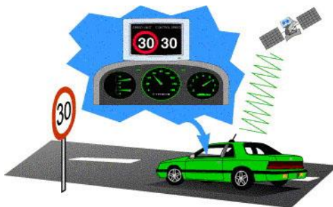
Figura 72. Sistemi për përshtatjen e shpejtësisë i bazuar në GPS
