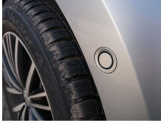
Figura 26. Sensor standard i vendosur në trupin e mjetit
