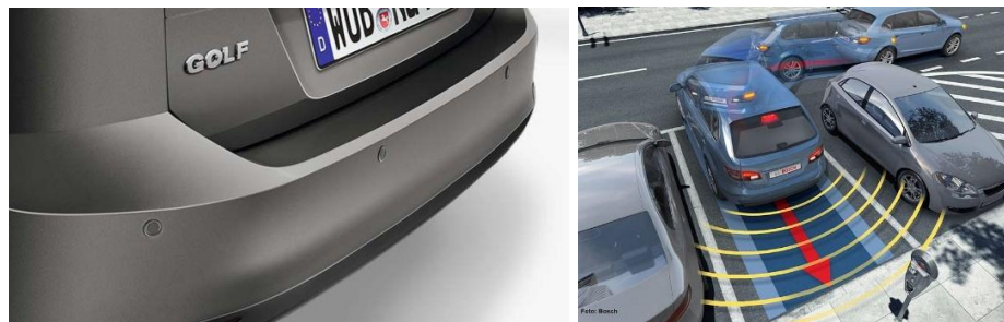
Figura 27. Sensorët në pjesën e prapme të automjetit
