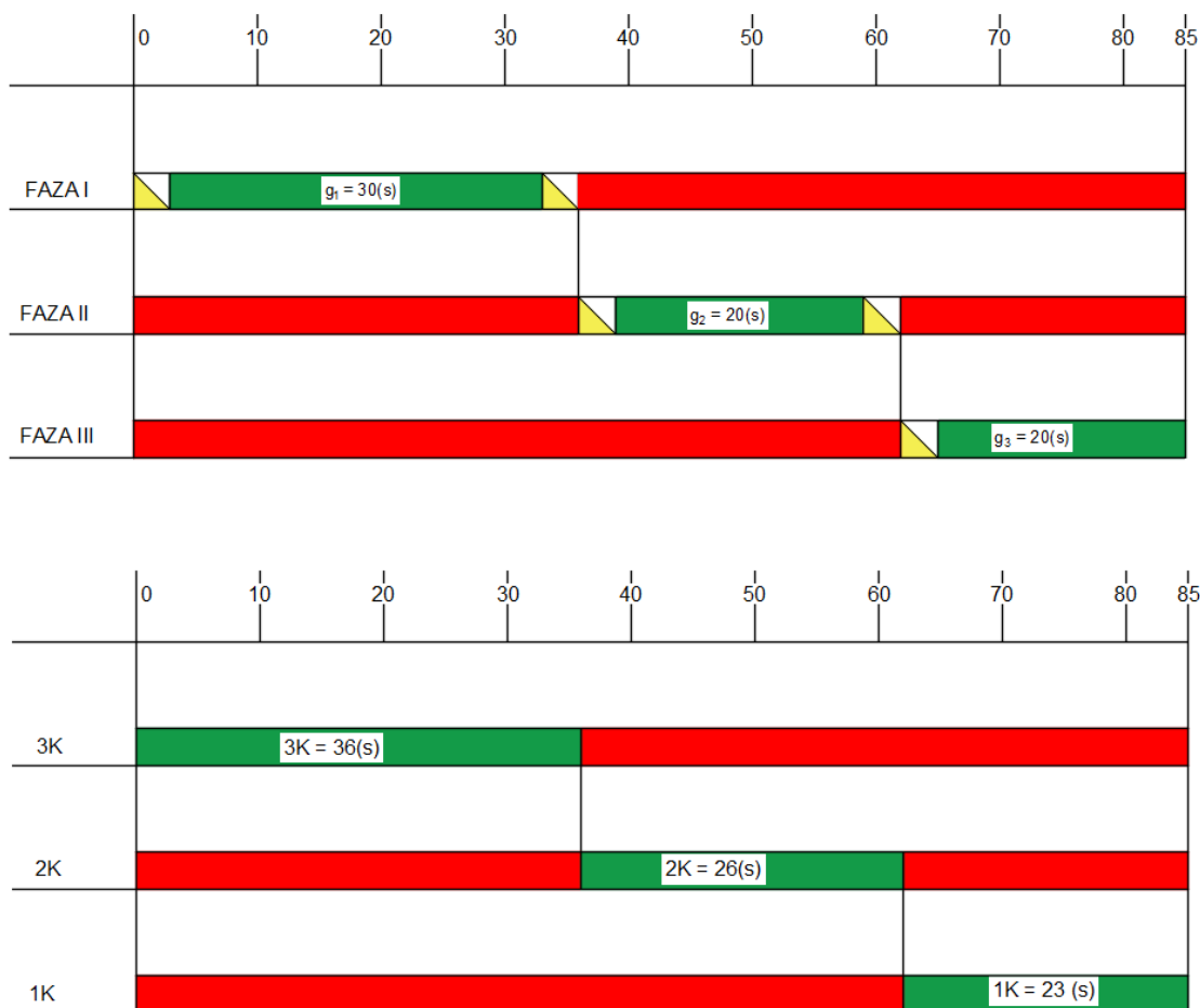
Fig. 7.8. Plani i akordimit për udhëkryqin e katërtë.
